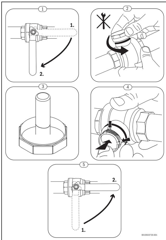
Bild 14 Siebreinigung
