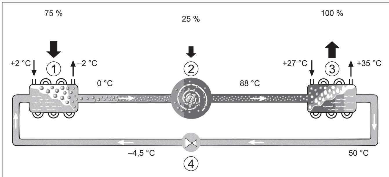
Bild 6 Funktionsprinzip des Kältemittelkreises in der Wärmepumpe
