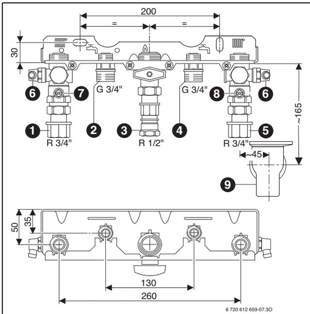
Bild 9 Beispiel: Montageanschlussplatte Nr. 993 Speicheranschluss Aufputz
