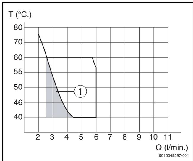
Bild 35 Diagramm für eine Kaltwassereinlauftemperatur von +10°C (ZWR/ZSR 18... K)
