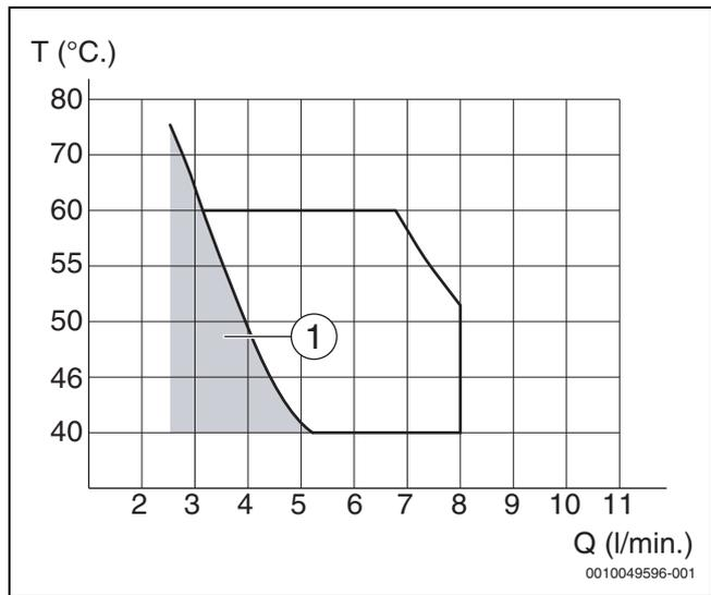
Bild 34 Diagramm für eine Kaltwassereinlauftemperatur von +10°C (ZWR/ZSR 24... K)
