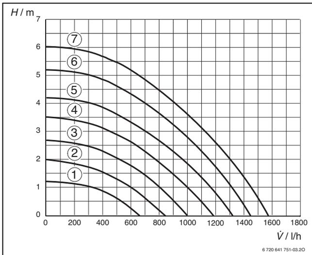
Bild 46 Pumpenkennlinien
