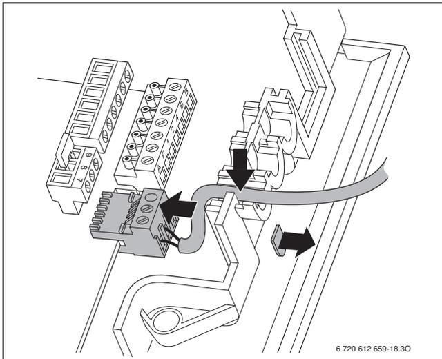
Bild 23 Anschluss Speichertemperaturfühler
