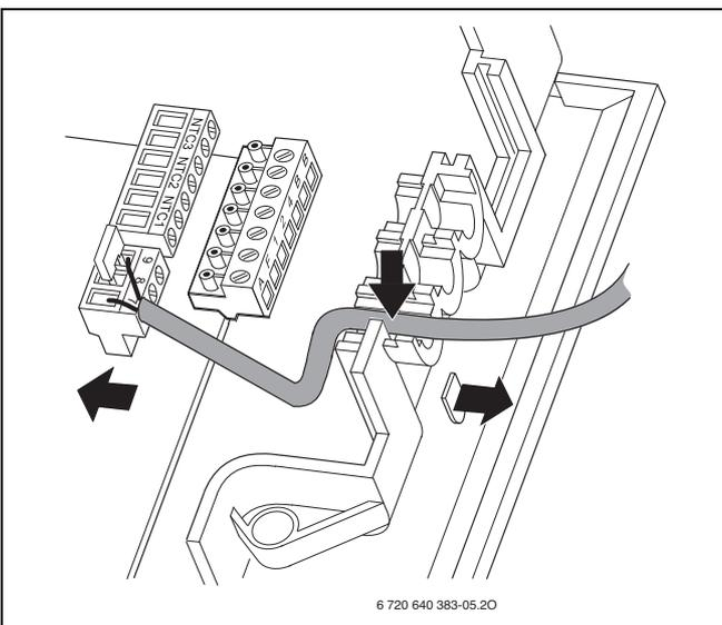
Bild 24 Anschluss Speicherthermostat
