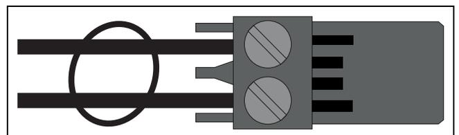
Bild 38 Kabelbinder am Steckverbinder
