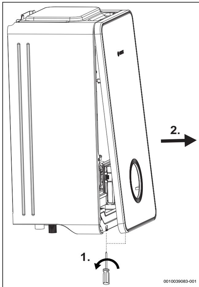
Bild 13 Frontplatten abnehmen
