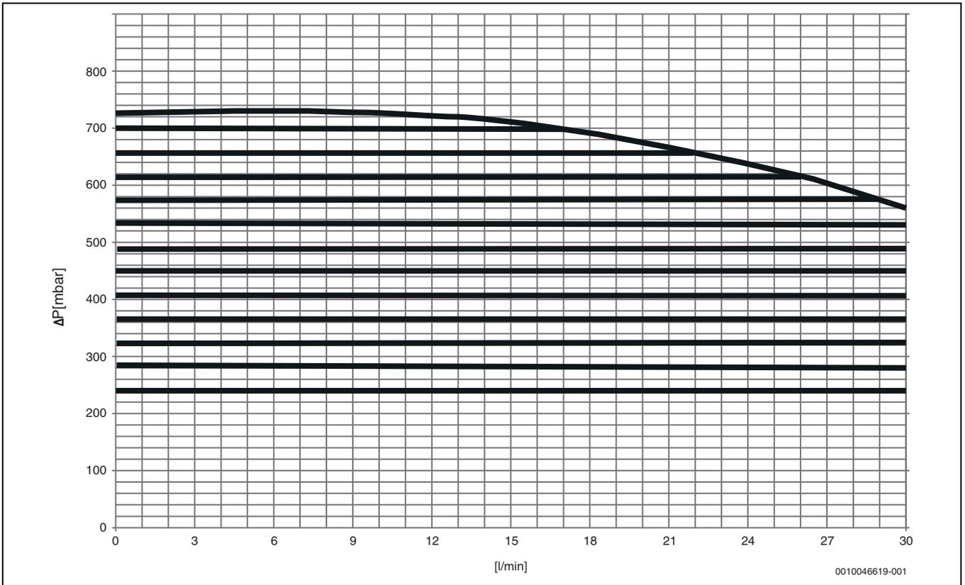
Bild 47 Leistungsdiagramm für Pumpe PC0
