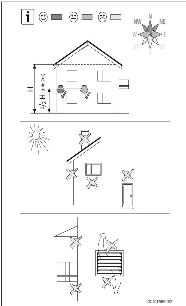
Bild 26 Position des Außentemperaturfühlers
