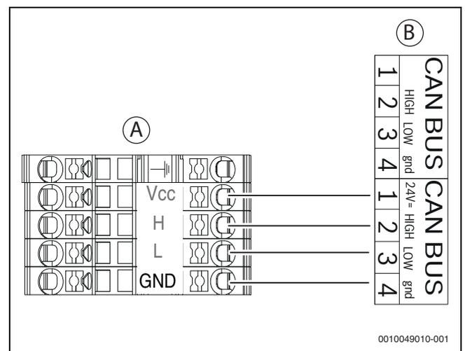
Bild 23 CAN-BUS Wärmepumpe - Inneneinheit
