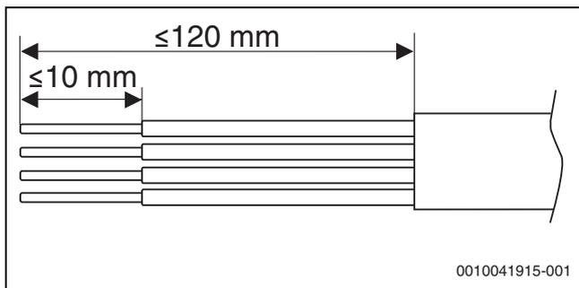
Bild 24 Abisolierung CAN-BUS
