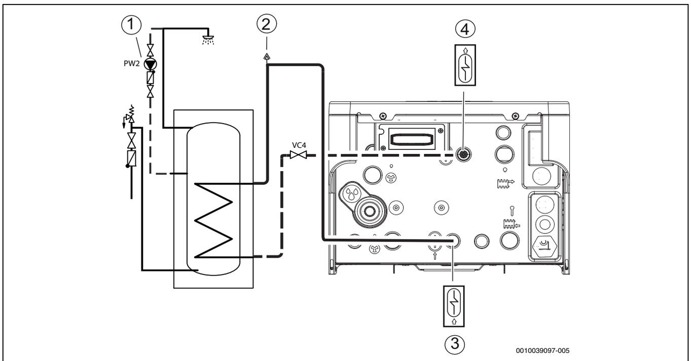
Bild 21 Trinkwasseranschlüsse Inneneinheit
