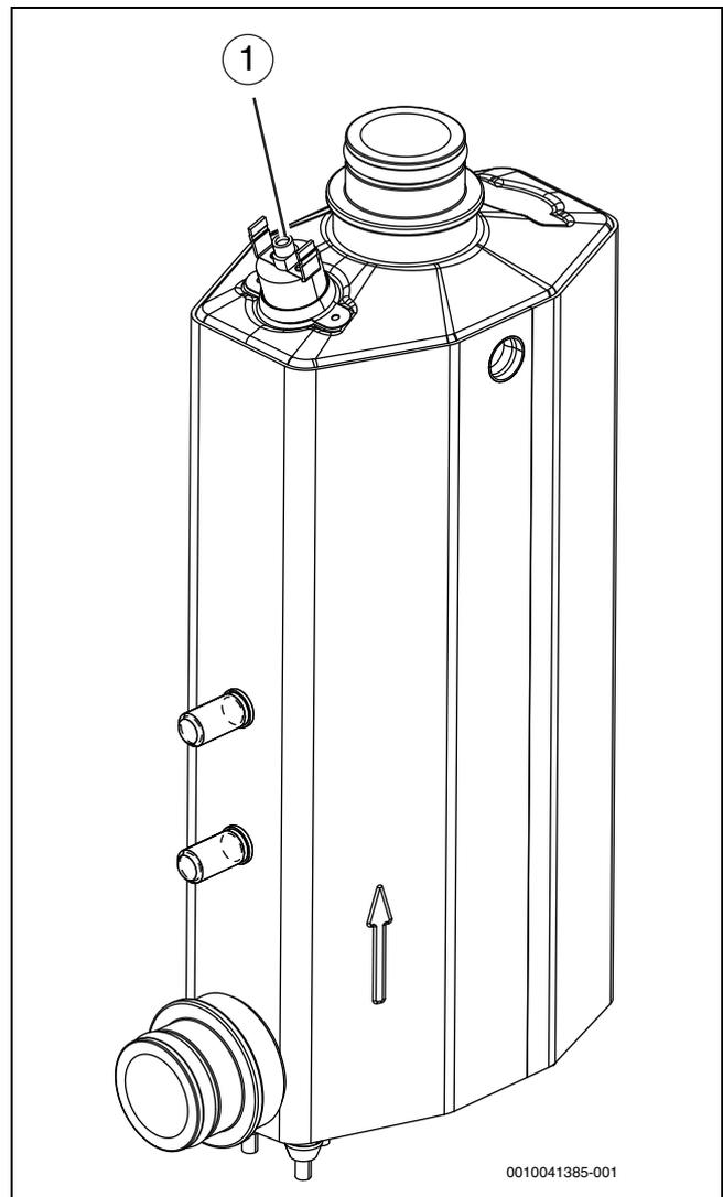
Bild 42 Elektrischer Zuheizer
