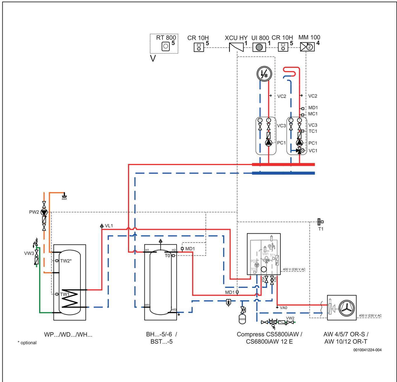
Bild 46 Wärmepumpe, zwei Heizkreise, Inneneinheit, Pufferspeicher und Warmwasserspeicher
