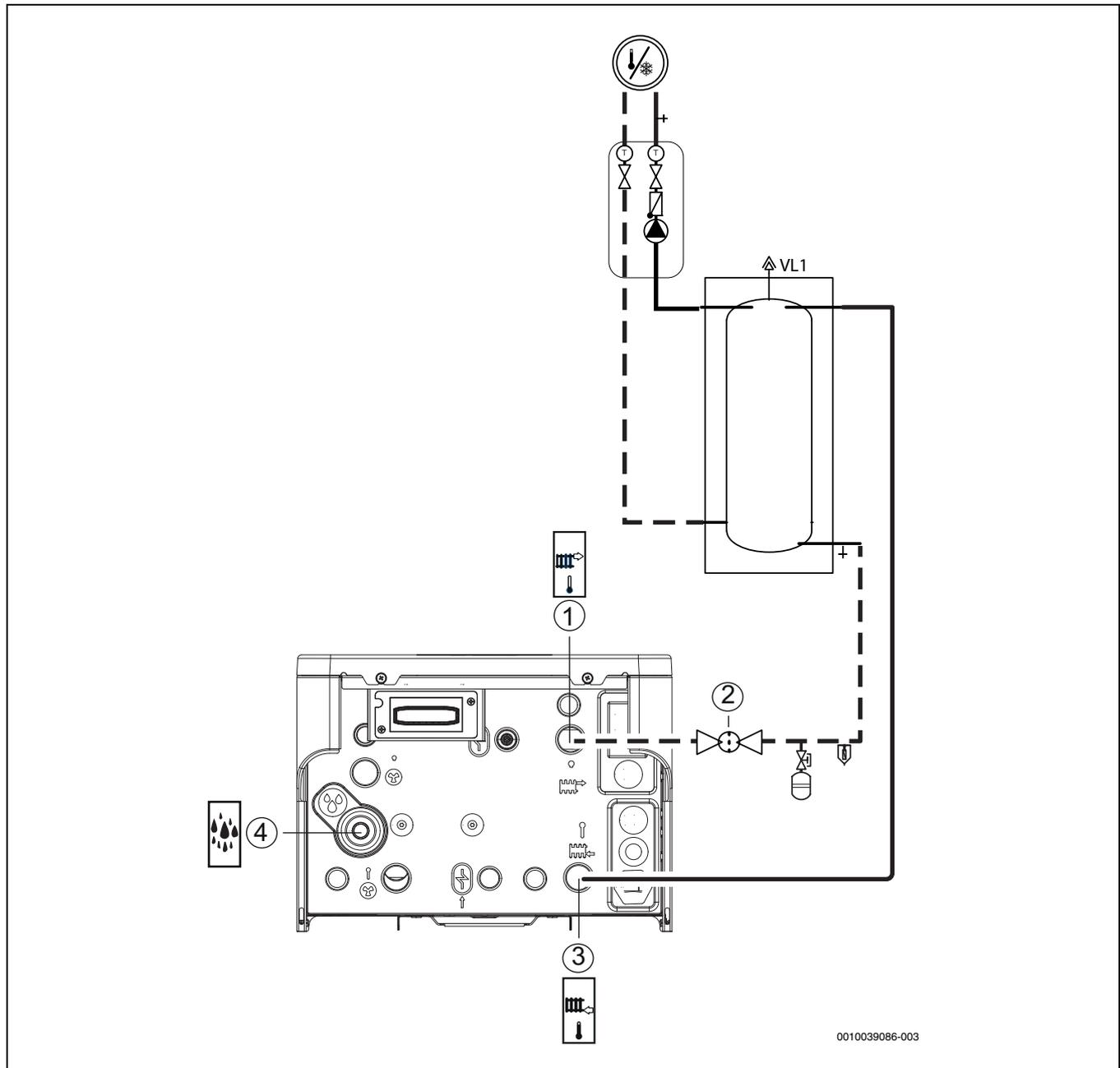
Bild 20 Anschluss der Inneneinheit an die Heizungsanlage
