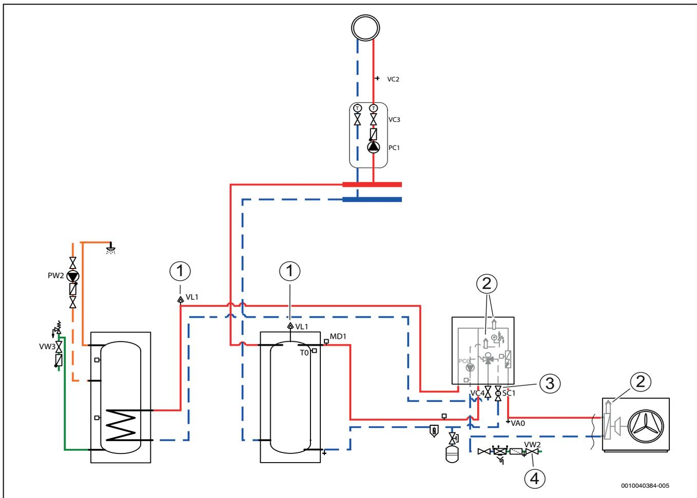
Bild 22 Inneneinheit, Wärmepumpe, Warmwasserspeicher und Heizungsanlage mit Puffer
