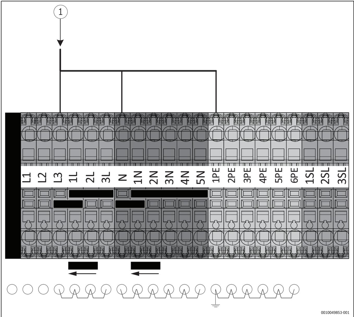
Bild 34 Elektrischer Anschluss, einphasig, nur 3 kW
