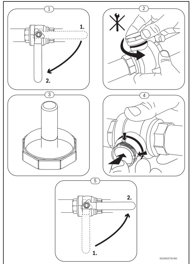
Bild 43 Siebreinigung
