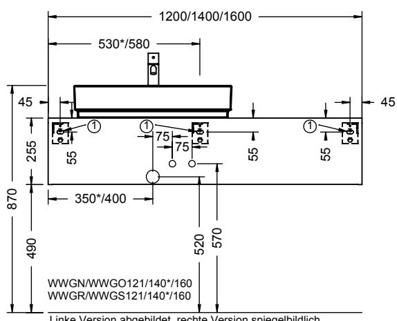
**Stockschrauben sind im Lieferumfang nicht enthalten!** // Hanger bolts are not included in the delivery! // Les vis sans tête à filetage partiel bois ne sont pas fournies. // De producten moeten aan alle geplande montagepunten bevestigd worden. // Le viti a doppia filettatura non sono fornite in dotazione! // Винты-шурупы не входят в комплект поставки!
