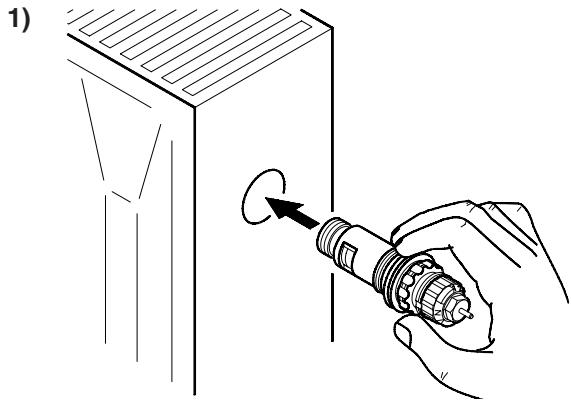
Monter indbygningsventilen i radiatoren.
