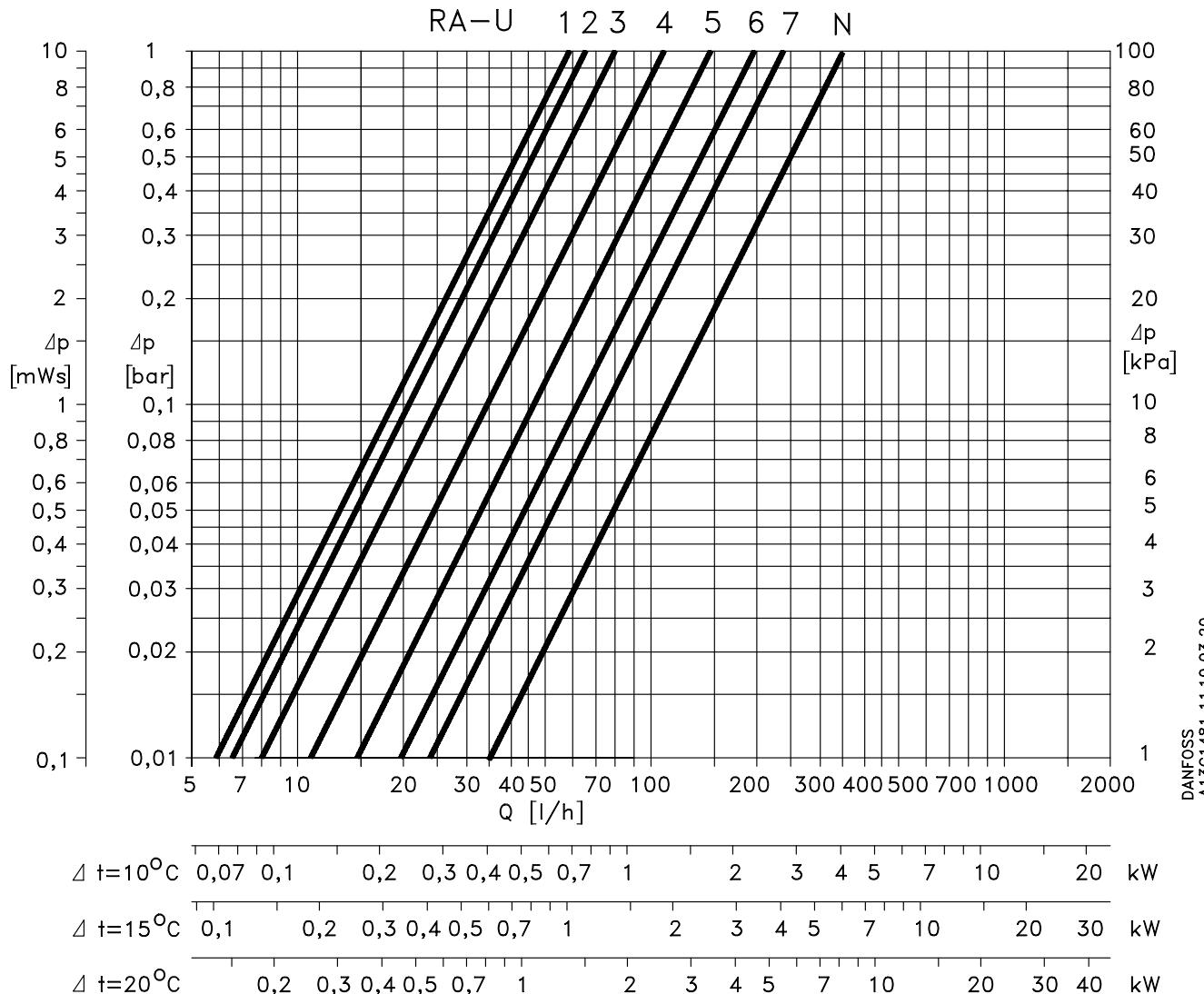
Kapaciteter er angivet ved  $X_p = 2$  K med Danfoss følerelement RA 2000 uden radiator og tilslutningsarmatur ( $mWs = mvs$ ).
