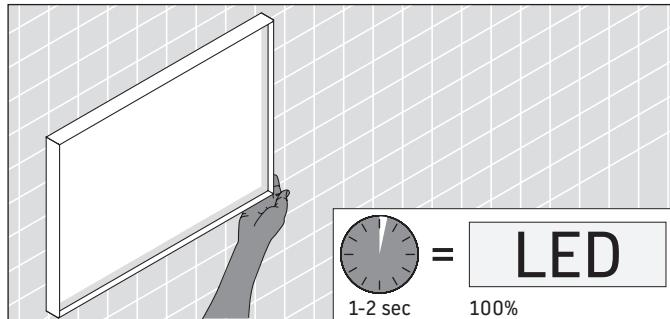
> Placez la main sous le capteur du variateur pendant 1-2 secondes afin d'augmenter au maximum la luminosité.
