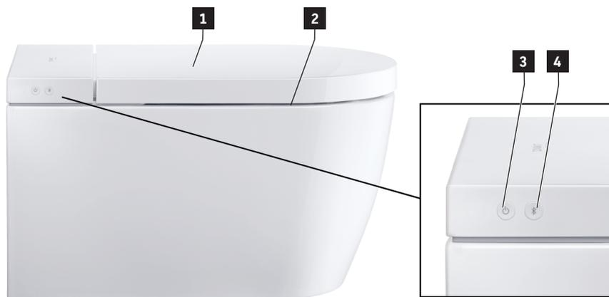
**1** Сензор (безконтактно отваряне на капака)\*
