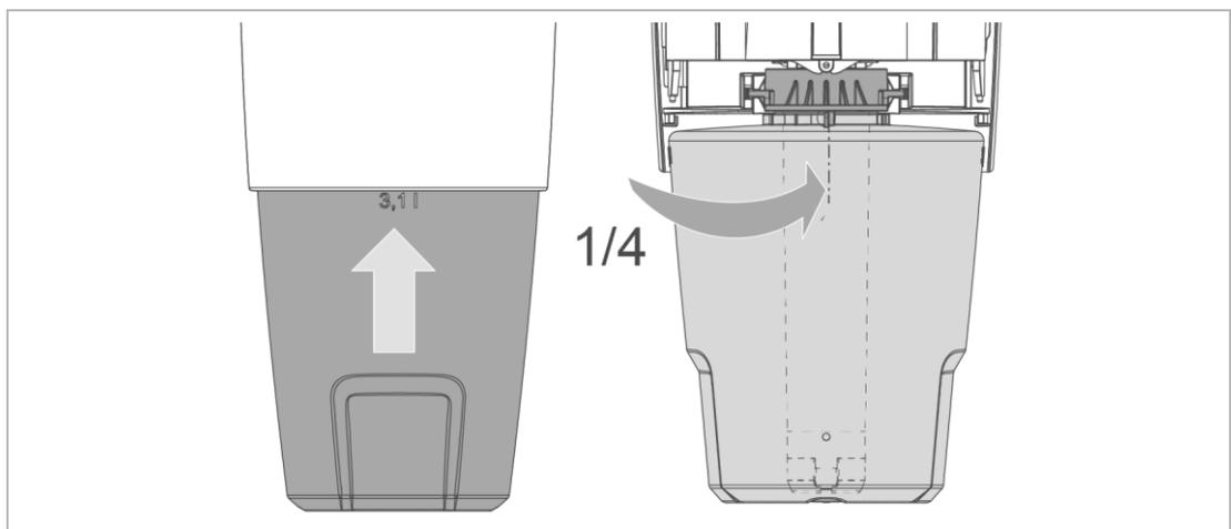
4. Drehen Sie die Flasche eine 1/4-Umdrehung bis zum Anschlag gegen den Uhrzeigersinn.
