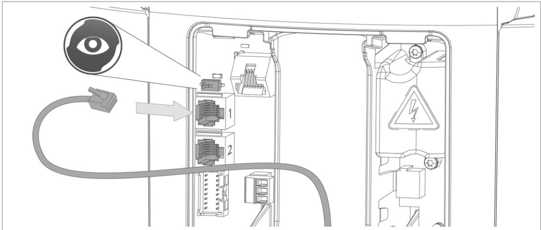
6. Verbinden Sie das iQ-Comfort-Verbindungskabel mit der Enthärtungsanlage (siehe entsprechende Betriebsanleitung).
