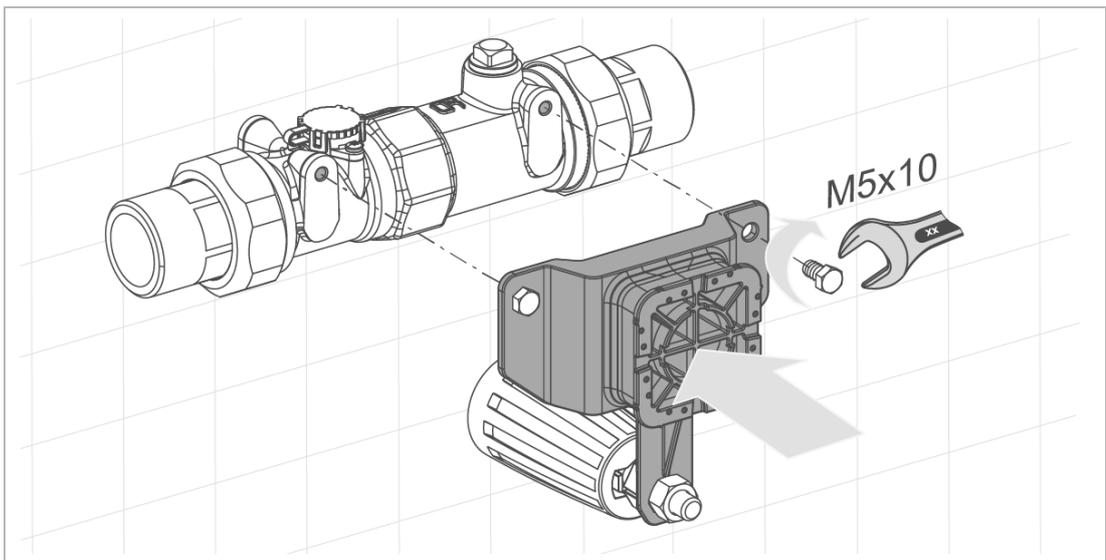
1. Schrauben Sie den Halter mit den Sechskantschrauben an den Wasserzähler.
