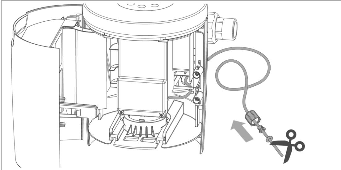
Die Dosierleitung ist an der Pumpe angeschlossen und zugfrei aus dem Gehäuse geführt.
