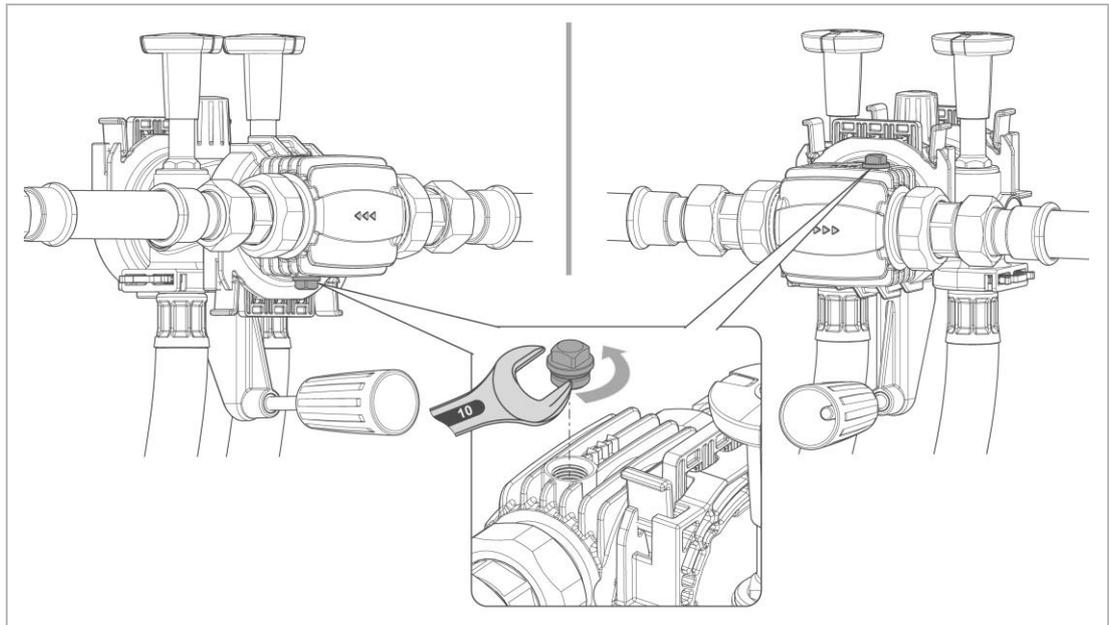
1. Demontieren Sie den Blindstopfen am cliQlock-Basismodul.
