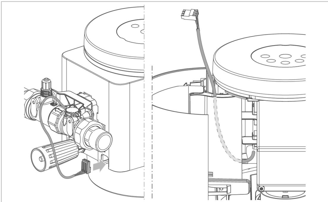
1. Führen Sie das Impulskabel des Wasserzählers zug- und knickfrei durch die Öffnung im Gehäuse.
