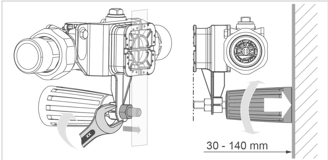
2. Stellen Sie die Gewindestange bündig mit der Anlagefläche ein.
