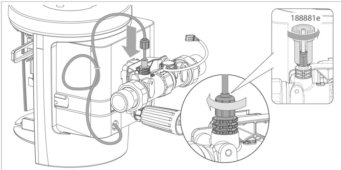
4. Führen Sie das Leitungsende bis zum Anschlag in das Dosierventil ein.
