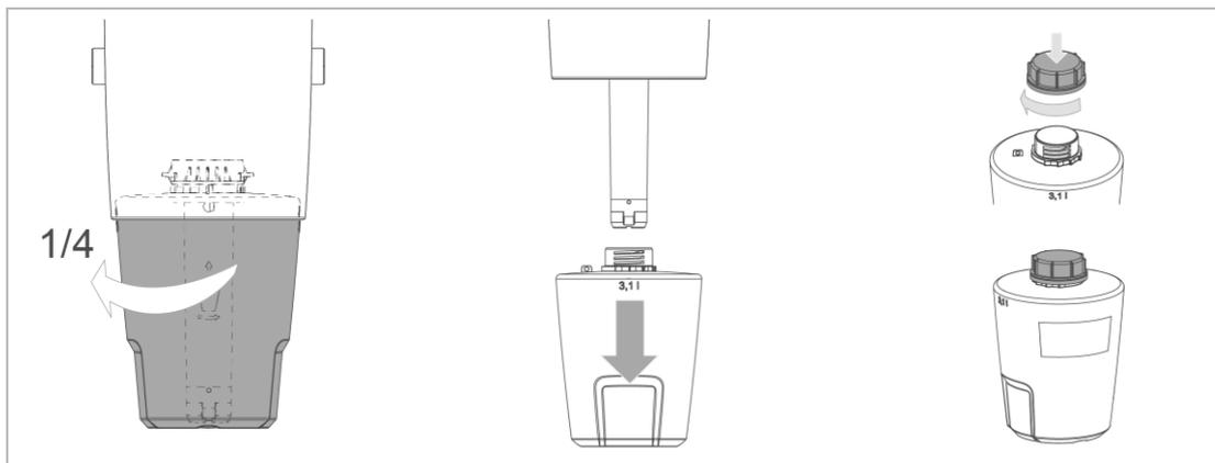
1. Drehen Sie die Flasche eine ¼-Umdrehung im Uhrzeigersinn.
