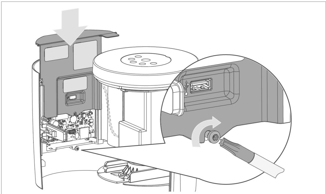
1. Schieben Sie die Abdeckung der Platine von oben ein.
