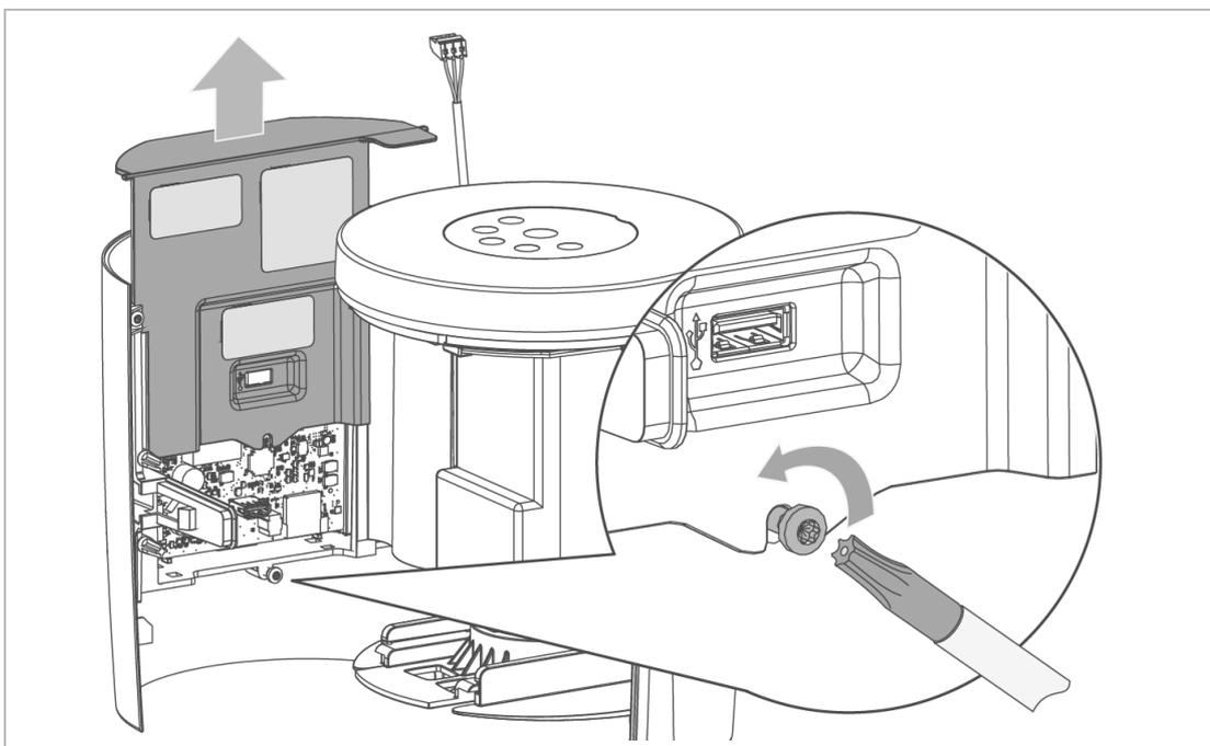
3. Lösen Sie die Torx-Schraube (T 20) – nicht herausschrauben.
