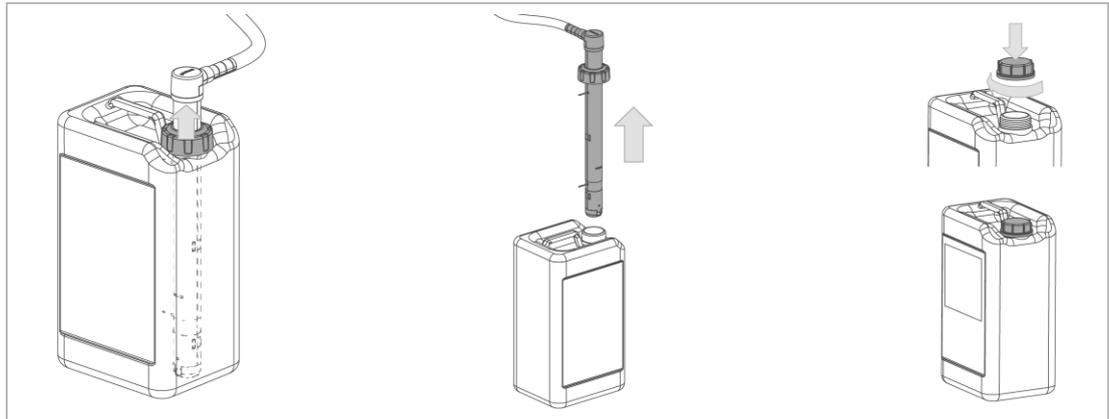
1. Lösen Sie den Schiebedeckel – nach oben ziehen.
