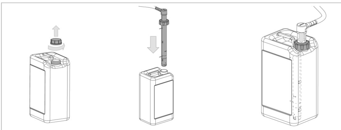
1. Lösen Sie den Schraubdeckel.
