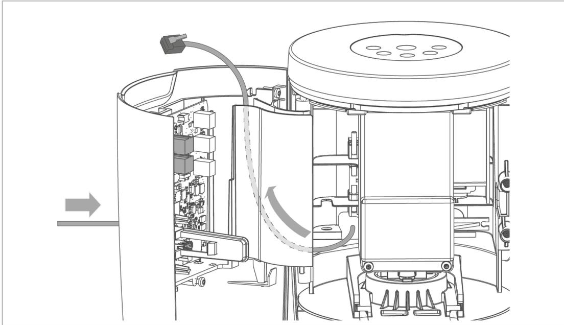
1. Führen Sie das iQ-Comfort-Verbindungskabel zug- und knickfrei durch die Öffnung im Gehäuse.
