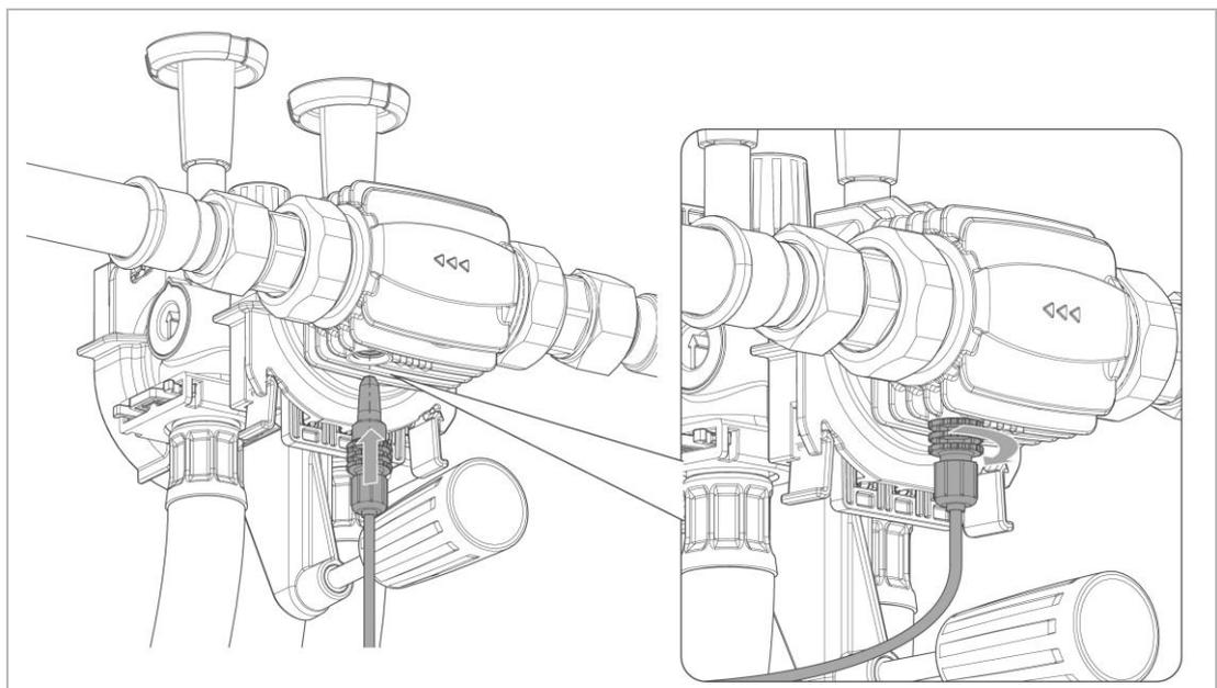
2. Montieren Sie das Dosierventil – handfest einschrauben.
