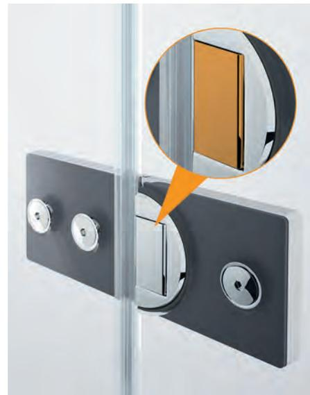
Der Hebesenkmechanismus - dezent hinter einer Kappe versteckt - hebt die Tür beim Öffnen leicht an. Dies schont die unteren Dichtleisten und sorgt für ein fast automatisches Schließen der Türen.
