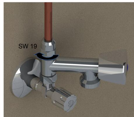
Kupferrohr / Flexschlauch bis zum Anschlag durch die Quetschverschraubung drücken und mit dem Gabelschlüssel festziehen.
