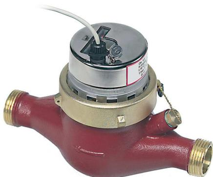
Die Durchflusssensoren AN 130 sind Mehrstrahl-Flügelrad-Heißwasserzähler als Trockenläufer, geeignet zum Einbau in Zentralheizungen und Fernwärmanlagen. Mit dem eingebauten Impulsgeber sind sie als Durchflusssensoren entsprechend der Europäischen Messgeräte-Richtlinie 2014/32/EU (MID) für Wärmehzähler zugelassen.
