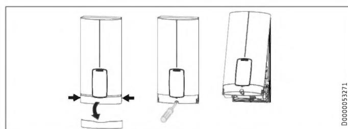
► Otevřete přístroj tím, že uchopíte na boku clonu a stáhněte ji z víka přístroje dopředu. Povolte šroub. Vyklopte víko přístroje.
