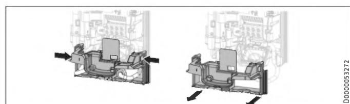
► Demontujte zadní stěnu zatlačením obou pojistných háčků a stáhněte spodní díl zadní stěny dopředu.
