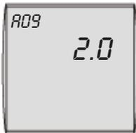
Unterschreitet die Aussentemperatur den eingestellten Wert, läuft die Kesselkreispumpe ständig. Sinkt die Kesselwassertemperatur unter +5°C schaltet der Brenner ein und heizt den Kessel mindestens auf TK - min. auf.
