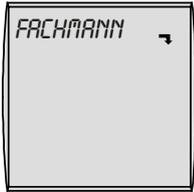
Rechten Drehknopf drücken um in die 2. Bedienebene zu wechseln. Durch Drehen des rechten Drehknopfs im Uhrzeigersinn die Menüebene „Fachmann“ anwählen und durch erneutes Drücken des rechten Drehknopfs die Auswahl bestätigen.
