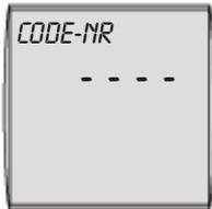
Der richtige Code wird durch Drücken (Anzeige blinkt im Display) und anschließendes Drehen des rechten Drehknopfs, **von 0 auf 1**, eingestellt. Nachdem der Code von 0 auf 1 verändert ist, wird durch erneutes Drücken des rechten Drehknopfs die Einstellung bestätigt und man befindet sich in der Fachmannebene.
