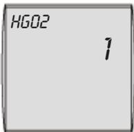
Innerhalb des Modulationsbereiches kann die untere Brennerleistung im Heizbetrieb angepasst werden. Die Einstellung bezieht sich auf die maximale Heizleistung in KW (siehe Tabelle „Maximale Heizleistung begrenzen“)
