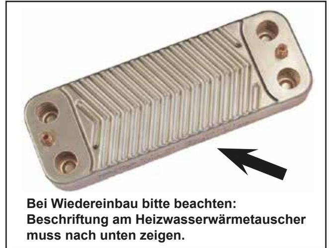
**Bei Wiedereinbau bitte beachten: Beschriftung am Heizwasserwärmetauscher muss nach unten zeigen.**
