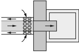
Der Anschluss an Abgasschornstein mit Luftöffnungen muss direkt am Abgasschornstein gemäß Bild installiert werden, damit alle Teile des Abgasweges verbrennungsluftumspült sind.
