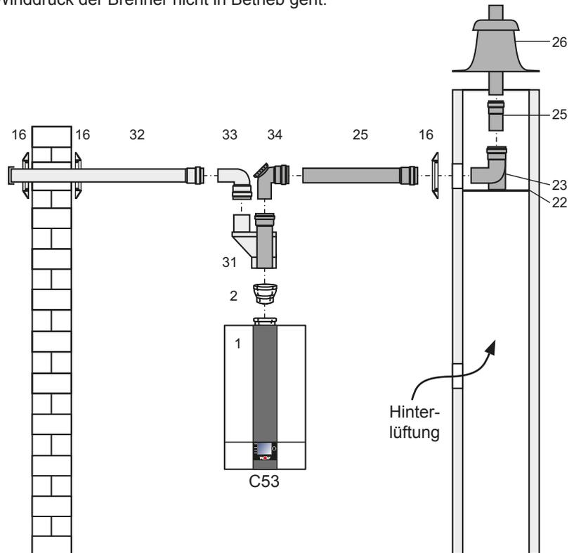
Zwischen Abgasleitung und Schachttinnenwand ist folgender lichter Abstand einzuhalten: bei rundem Schacht: 3 cm
