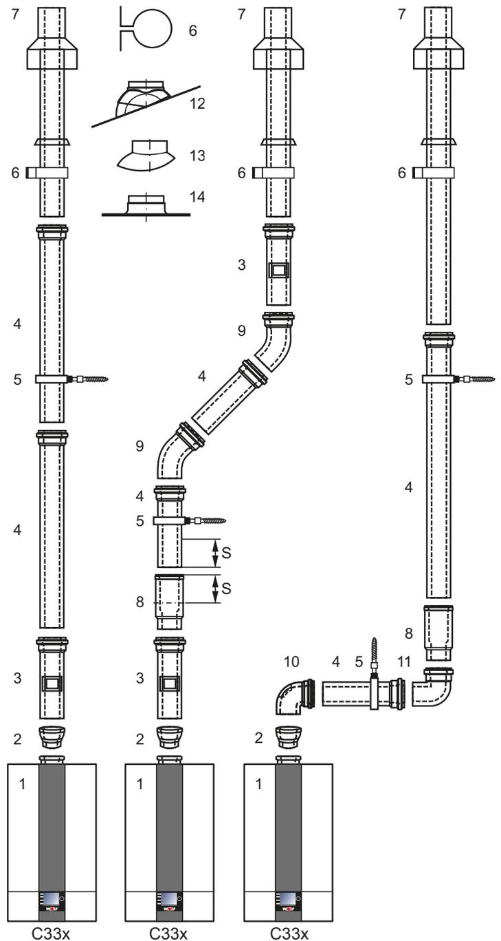
**Art C33x:** Gasbrennwertgerät mit Verbrennungsluftzu- und Abgasführung senkrecht über Dach.
