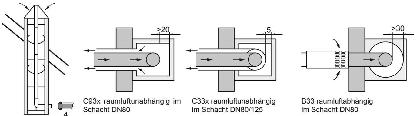
C93x raumluftunabhängig im Schacht DN80
