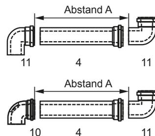
Abstand A bestimmen. Länge Luft-/Abgasrohr (4) immer ca. 100mm länger als Abstand A. Abgasrohr immer auf der glatten Seite kürzen, **nicht** auf Muffenseite.
