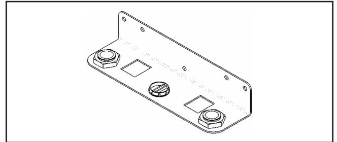
Bild: Anschlusskonsole für Überputzausführung (Zubehör)
