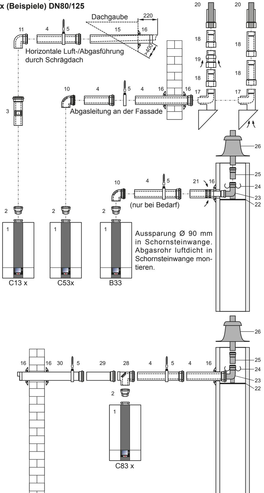
Die waagrechte Abgasführung ist mit ca. 3° Gefälle (6cm/m) zum Gerät zu montieren. Die waagrechte Luftführung ist mit ca. 3° Gefälle nach außen zu verlegen - Luftansaug mit Windschutz ausführen; zulässiger Winddruck am Lufteintritt 90 Pa, weil bei einem höheren Winddruck der Brenner nicht in Betrieb geht. Im Schacht kann nach dem Stützbogen (23) die Abgasleitung in DN80 verlegt werden. Eine flexible Abgasleitung DN83 kann nach dem Stützbogen (23) angeschlossen werden.
