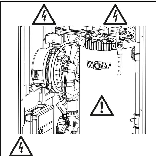
Bild: Zündtrafo, Hochspannungs-Zünderlektrode, Brennkammer
