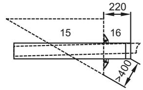
Trennvorrichtung (8) bei Montage bis zum Anschlag in die Muffe schieben. Nachfolgendes Luft-/Abgasrohr (4) 50 mm (Maß „S“) in die Muffe der Trennvorrichtung schieben und in dieser Position unbedingt Lage fixieren z.B. mit Rohrschelle DN125 (5) oder luftseitig mit Sicherungsschraube.
