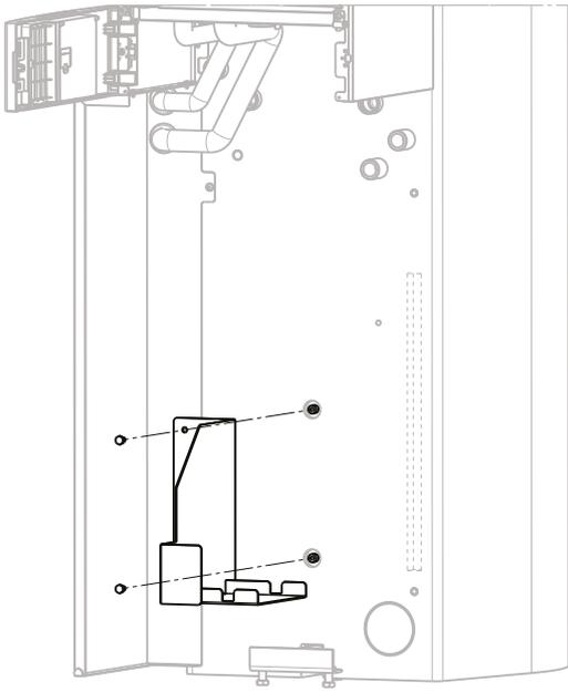
Halter Ausdehnungsgefäß (Pos 19) mit 2 x Schraube am Speicher (Pos 10.6) befestigen
