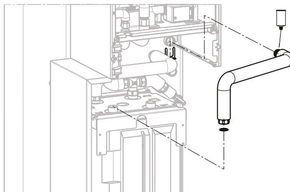
Wellrohr Rücklauf Heizung (Pos. 20.8) Art. Nr. 2072407 an O-Ring-Seite einfetten, in die Steckverbindung Rücklauf HK in den Speicher stecken und mit rechteckigen Clip (Pos. 20.12) sichern.
