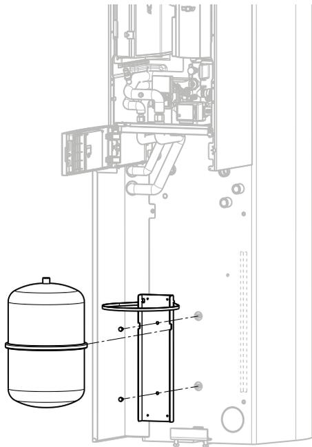
Halteband (In Pos. 14 verpackt) an Haltewinkel (Pos. 15) anbringen und mit Schrauben (Pos. 10.6) am Speicher befestigen. Ausdehnungsgefäß mittels Halteband montieren
