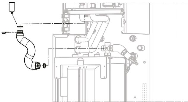
Wellrohr Rücklauf Gerät (Pos. 20.5) Art. Nr. 2072399 mit O-Ring (Pos. 20.14) versehen, einfetten und in die Inneneinheit einstecken und mit dem Verrohrungsclip DN 28 (Pos. 20.13) sichern.
