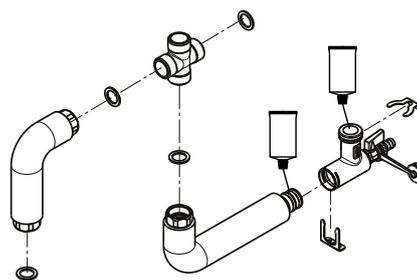
KFE-Kugelhahn (Pos. 2.15) in Anschlusswinkel (Pos. 2.1) einschrauben. O-Ring (Pos. 2.4) in Nut am Anschlusswinkel einsetzen und einfetten. Wellrohr an O-Ring-Seite einfetten, in Anschlusswinkel einstecken und mit rechteckigem Clip (Pos. 2.2) sichern. Beide Wellrohre (Pos. 2.5 und 2.8) unter Verwendung von Flachdichtungen (Pos. 2.9) mit Kreuzstück (Pos. 2.11) verschrauben. Flachdichtungen (Pos. 2.9) für anschließende Montage vorbereiten
