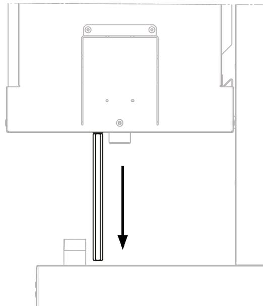
Distanzhülse zum Ausrichten des PU-35 bis zum Speicher heraus-schrauben
