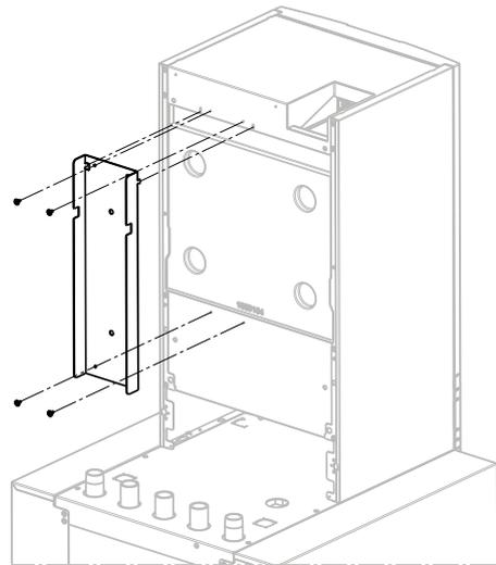
Halter Ausdehnungsgefäß (Pos. 5.1) mit Schrauben (Pos. 5.6) befestigen
