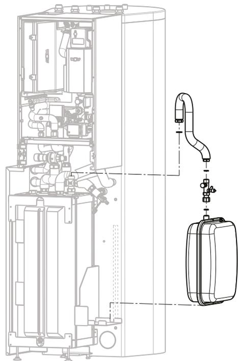
Ausdehnungsgefäß (Pos. 18) mit Kappenventil (Pos. 17.12), Wellrohr DN 15 (Pos. 17.11) und Flachdichtungen (Pos. 17.17 und 17.18) am Kreuzstück festschrauben
