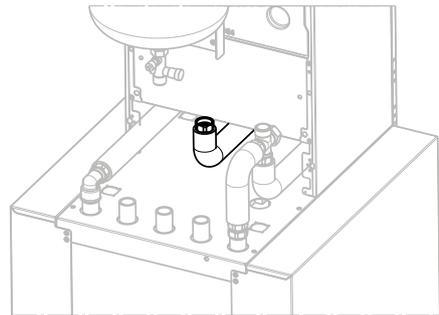
Vormontiertes Wellrohr (siehe Schritt 10.13) mit dem Anschlusswinkel in die Inneneinheit stecken und mit Verrohrungsclip DN 28 (Pos. 2.3) sichern
