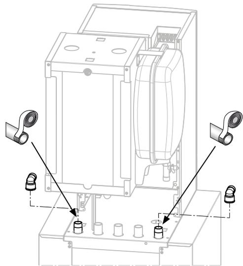
2 x Anschlussbogen (Pos. 8.3) an Rohrgewindeanschluss (VL Speicher) und (RL Speicher) mit geeignetem Dichtmaterial aufdichten. Anschlüsse müssen in Richtung der Inneneinheit zeigen
