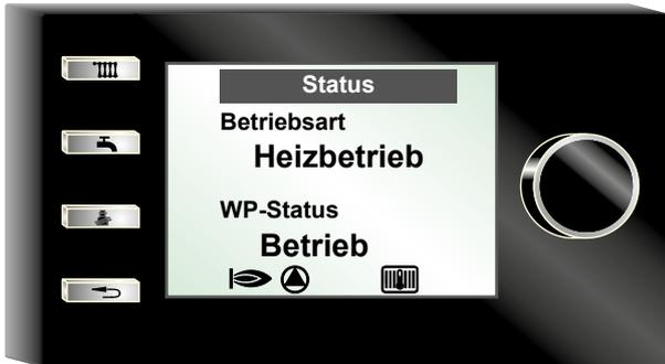
Das AM dient als Anzeige- und Bedienmodul für die Split-Luft/Wasser-Wärmepumpe. Es können Split-Luft/Wasser-Wärmepumpenspezifische Parameter und Werte parametrisiert bzw. angezeigt werden.
