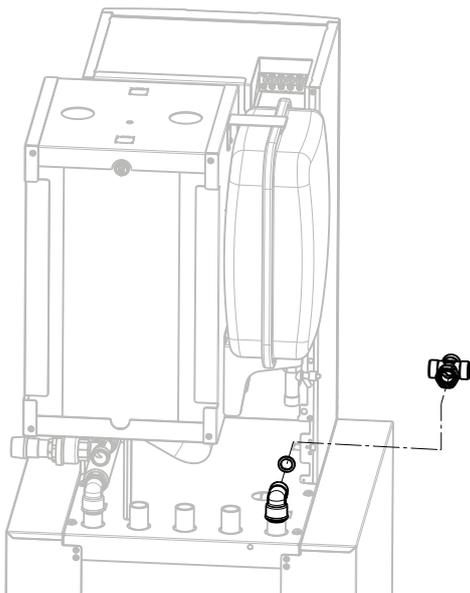
Kreuzstück (Pos. 8.5) mit Überwurfmutter-Seite und Flachdichtung (Pos. 8.20) an den zuvor montierten Anschlussbogen am RL Speicher montieren
