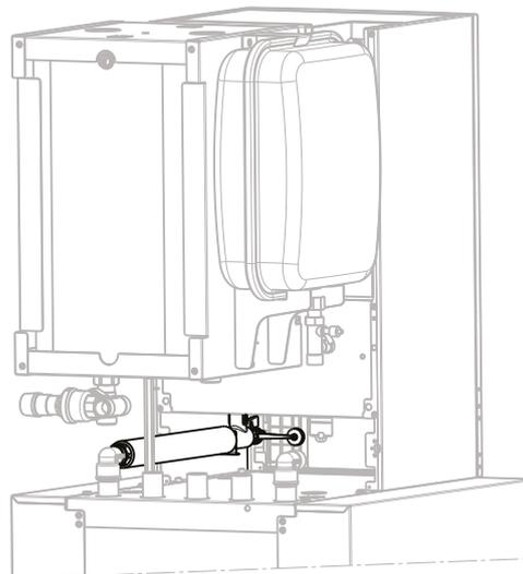
Vormontiertes Wellrohr (siehe Schritt 11.18) inkl. Flachdichtung mit Anschlussbogen VL Speicher verschrauben, den Anschlusswinkel am Wellrohr mit der Inneneinheit verbinden und mit Verrohrungsclip DN 28 (Pos. 8.16) sichern
