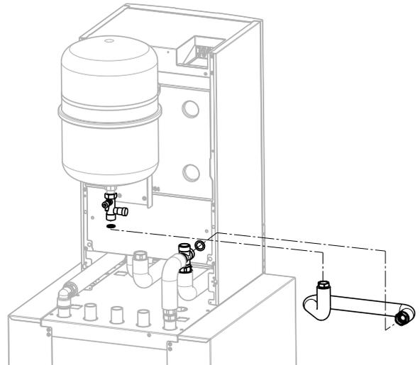
Wellrohr DN15 (Pos. 5.2) gemäß Bild vorbeugen und dann unter Verwendung der Flachdichtungen (Pos. 5.4 und 5.5) mit Kreuzstück und Ausdehnungsgefäß verbinden
