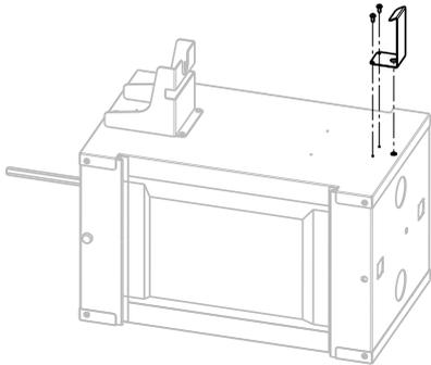
Lasche (Pos. 7.4) mit Schrauben (Pos. 7.7) montieren
