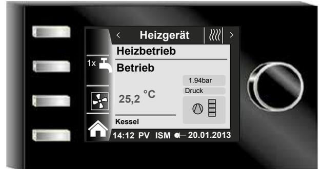
Das BM-2 (Bedienmodul) kommuniziert über eBus mit allen angeschlossenen Erweiterungsmodulen und mit der Split-Luft/Wasser-Wärmepumpe.
