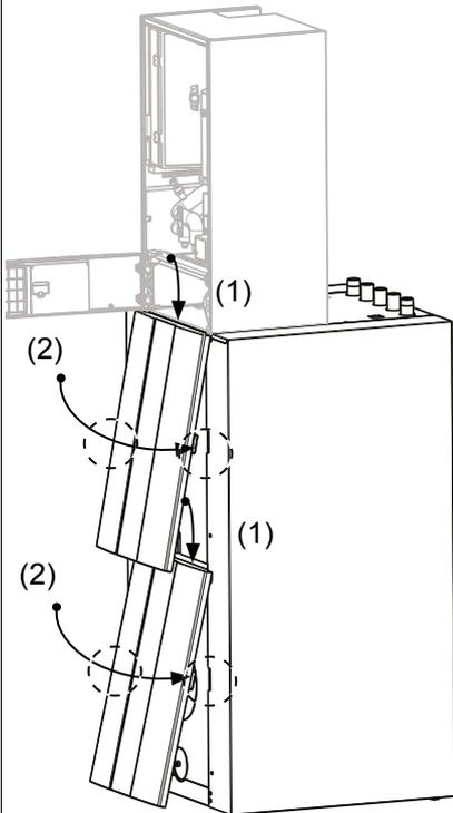
Frontverkleidung in umgekehrter Reihenfolge wieder montieren.
