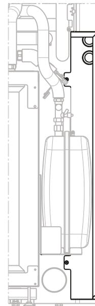
Seitenverkleidung rechts (Pos 10.1) analog zur Seitenverkleidung links mit Schrauben (Pos 10.4) montieren und Schlauch von Sicherheitsventil durch Durchführungen ziehen!
