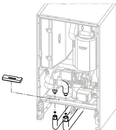
Rohrfixierung entfernen und Kältemittelleitungen (Pos. 3.1 und Pos 3.2) unter Verwendung der Kupfer-Dichtungen (Pos. 3.3) und (Pos. 3.4) an Inneneinheit anbringen und mit dem entsprechenden Drehmoment anziehen
