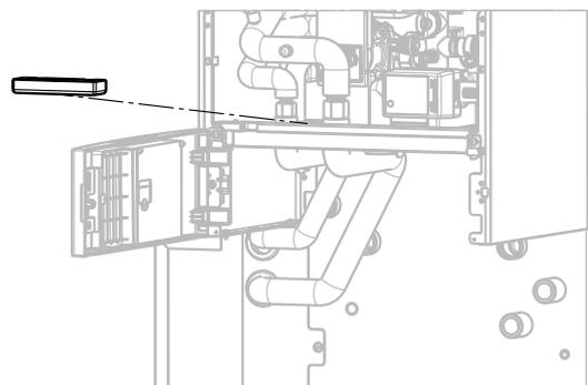
Rohrfixierung anschließend wieder einsetzen
