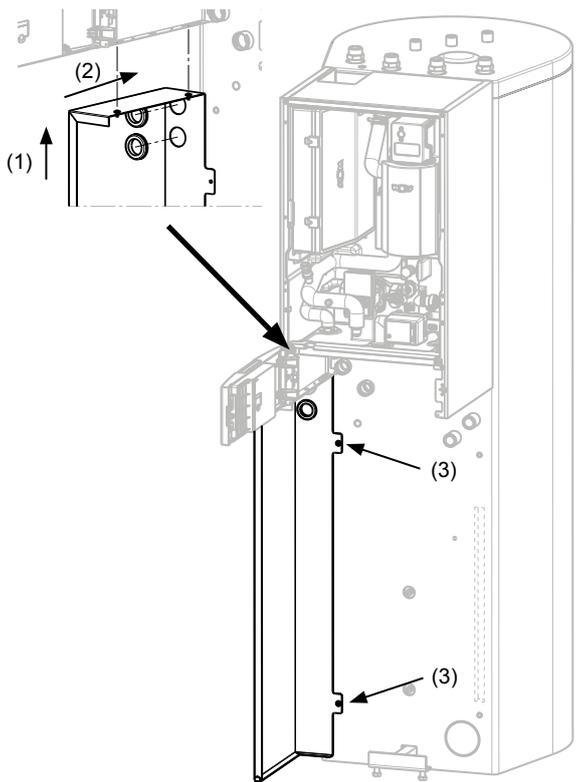
Einhängen der Seitenverkleidung links (Pos. 10.2) und einsetzen der Dichtmanschetten (Pos 10.3).
