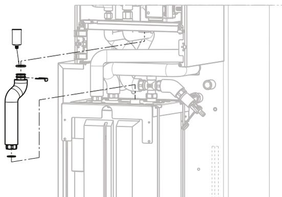
Wellrohr Vorlauf Puffer (Pos. 20.6) Art. Nr. 2072405 mit O-Ring (Pos. 20.14) versehen, einfetten und in die Inneneinheit einstecken und mit dem Verrohrungsclip DN 28 (Pos. 20.13) am Pufferspeicher „Anschluss 1“ festschrauben
