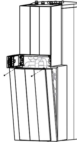
Frontblech mit Schrauben (Pos 10.5) montieren
