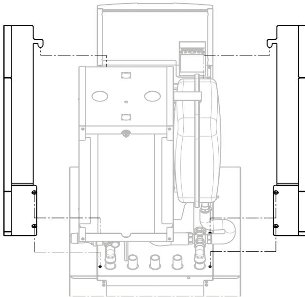
Seitenverkleidung links und Seitenverkleidung rechts
