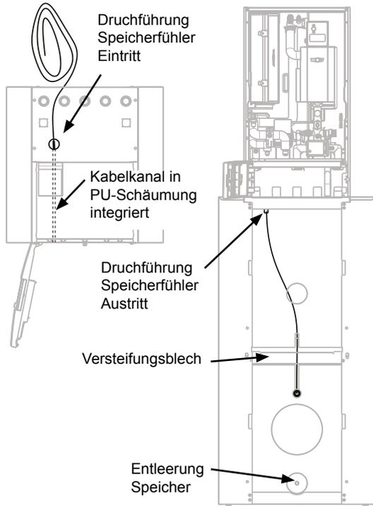
Kabel hinter den Versteifungsblech durchführen und in Tauchhülse einsetzen.
