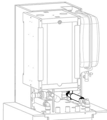
Vormontiertes Wellrohr (siehe Schritt 11.20) mit dem Anschlusswinkel in die Inneneinheit stecken und mit Verrohrungsclip DN 28 (Pos. 8.16) sichern. Überwurfmutter des Wellrohres mit Flachdichtung (Pos. 8.20) am Kreuzstück verschrauben
