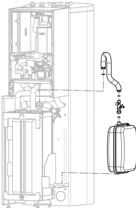
Ausdehnungsgefäß (Pos. 18) mit Kappenventil (Pos. 20.10), Wellrohr DN 15 (Pos. 20.9) und Flachdichtungen (Pos. 20.15 und 20.16) am Kreuzstück festschrauben
