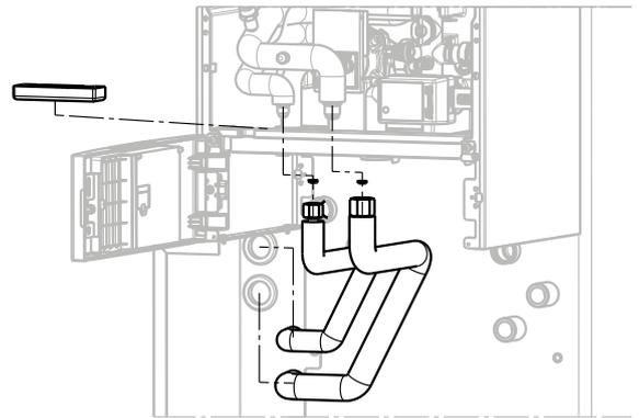
Rohrfixierung entfernen und Kältemittelleitungen (Pos. 13.1 und Pos. 13.2) unter Verwendung der Kupferdichtungen (Pos. 13.3 und Pos. 13.4) an Inneneinheit anbringen und mit dem entsprechenden Drehmoment anziehen
