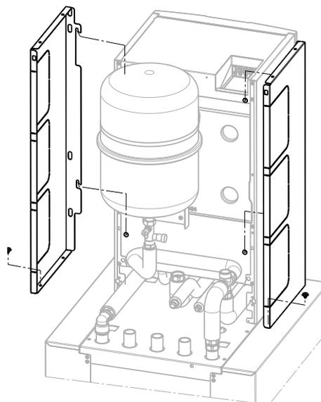
2 x Klammer (Pos. 1.3) in Seitenverkleidung links (Pos. 1.2) und rechts (Pos. 1.1) stecken
