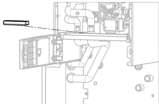
Rohrfixierung anschließend wieder einsetzen
