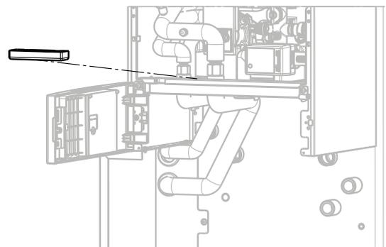
Rohrfixierung anschliessend wieder einsetzen
