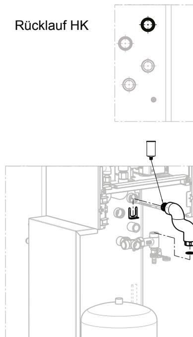
Wellrohr Rücklauf Heizung (Pos. 12.6) Art. Nr. 2072549 an O-Ring-Seite einfetten, in die Steckverbindung am Rücklauf HK in den Speicher stecken und mit dem rechteckigen Clip (Pos. 12.9) sichern. Überwurfmutter-Seite mit Flachdichtung (Pos. 12.13) am Anschlusswinkel festschrauben
