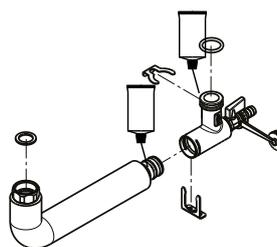
KFE-Kugelhahn (Pos. 2.15) in Anschlusswinkel (Pos. 2.1) einschrauben. Wellrohr Vorlauf Heizung (Pos. 2.6) Art. Nr. 2071920 an O-Ring-Seite einfetten, in Anschlusswinkel einstecken und mit rechteckigen Clip (Pos. 2.2) sichern. O-Ring (Pos. 2.4) in Nut am Anschlusswinkel einsetzen und einfetten. Flachdichtung (Pos. 2.9) für anschließende Montage vorbereiten
