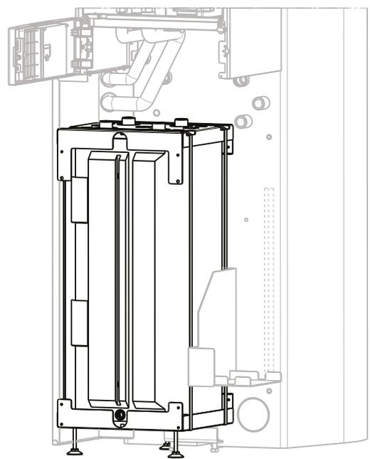
Pufferspeicher gemäß Bild zwischen Seitenverkleidung links und Einhängewinkel einbringen
