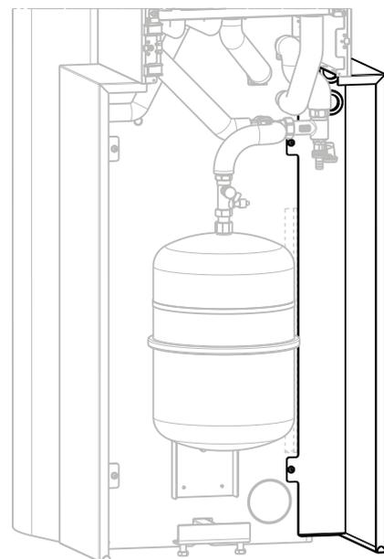
Einhängen der Seitenverkleidung rechts (Pos 10.1), einsetzen der Dichtmanschetten (Pos 10.3) und mit zwei Schrauben (Pos. 10.4) am Speicher festschrauben. Schlauch des Sicherheitsventils durch die Durchführung ziehen
