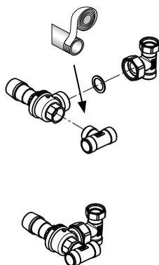
Überströmventil (Pos. 8.4) an der Eingangsseite mit T-Stück (Pos. 8.7) unter Verwendung von geeignetem Dichtmaterial verschrauben. Ausgangsseite mit Flachdichtung (Pos. 8.21) und T-Stück (Pos. 8.6) verschrauben. Die Ausrichtung der Bauteile gemäß Bild beachten
