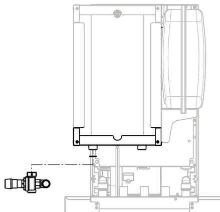
Vormontiertes Überströmventil gemäß Bild unter Verwendung der Flachdichtung (Pos. 8.20) an den Pufferspeicher schrauben
