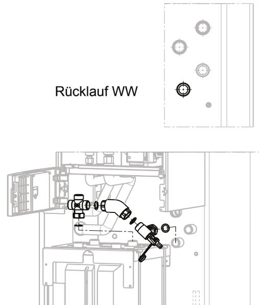
Kreuzstück (Pos. 20.1) mit Flachdichtung (Pos. 20.16) auf Pufferspeicher „Anschluss 2“ montieren. Wellrohr (Pos. 20.4) Art. Nr. 2072398 und Anschlusswinkel inkl. Entleerung (Pos. 20.2) mit Flachdichtungen (Pos. 20.16) an Kreuzstück und Speicher Rücklauf WW gemäß Bild montieren
