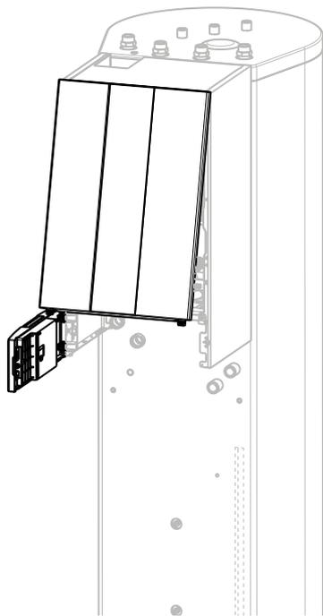
Aufklappen der Regelungsblende und entfernen der Frontverkleidung
