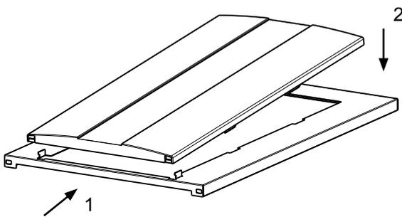
Frontverkleidung Hydraulik (Pos 11.1) in Frontblech
