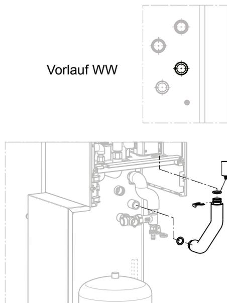
Wellrohr Vorlauf Speicher (Pos. 12.3) Art. Nr. 2072397 mit O-Ring (Pos. 12.11) versehen, einfetten und in die Inneneinheit einstecken und mit dem Verrohrungsclip DN 28 (Pos. 12.10) sichern. Überwurfmutter-Seite mit Flachdichtung (Pos. 12.13) am Vorlauf WW festschrauben
