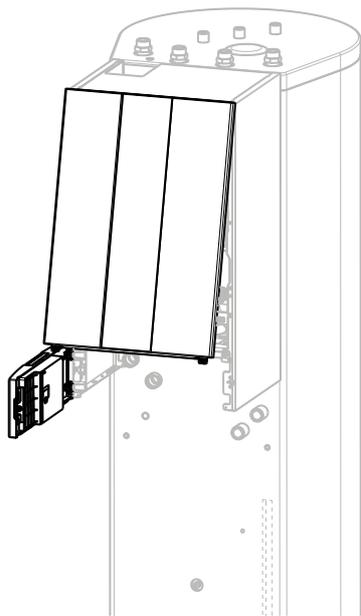
Aufklappen der Regelungsblende und entfernen der Frontverkleidung
