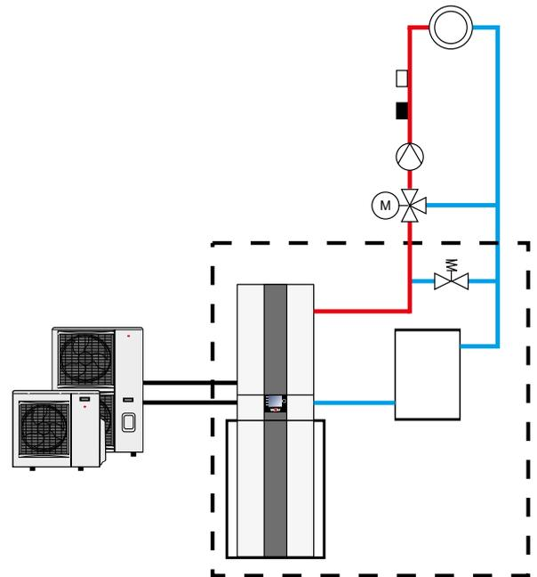
Wärmepumpencenter mit Reihenspeicher und Überströmventil (im System integriert) und Mischkreis
