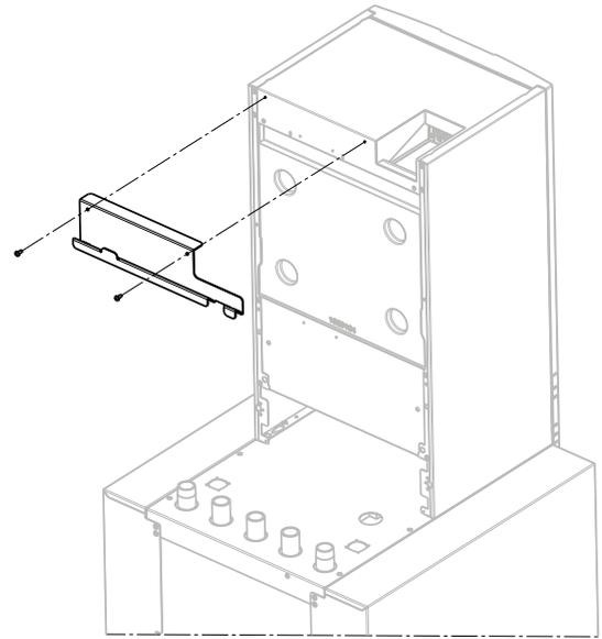
Einhängewinkel (Pos. 7.3) mit 2 x Schraube (Pos. 7.7) befestigen
