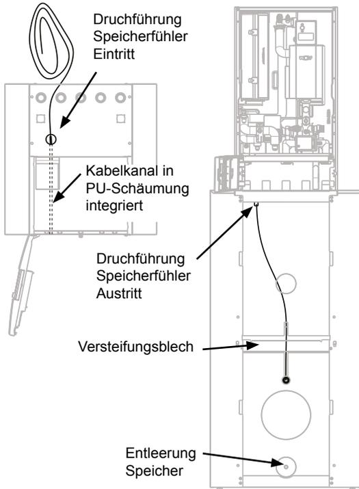
Kabel hinter den Versteifungsblech durchführen und in Tauchhülle einsetzen.
