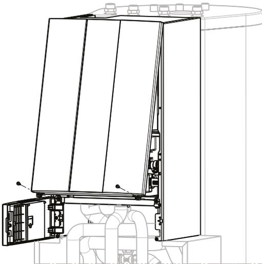
Frontverkleidung der Inneneinheit montieren
