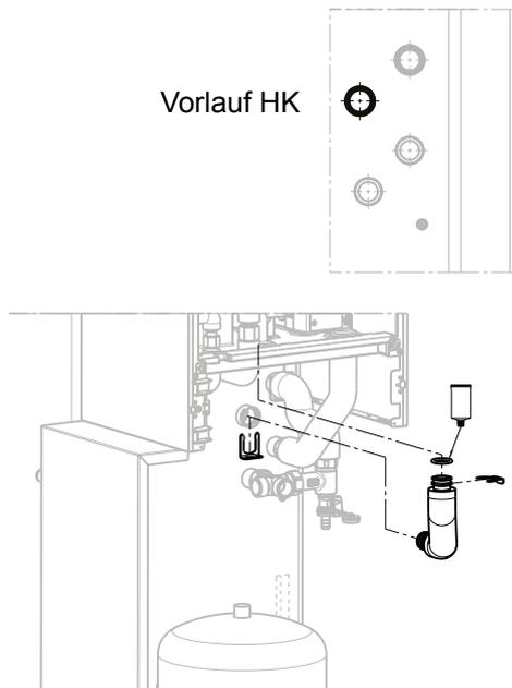
Wellrohr Vorlauf Heizung (Pos. 12.5) Art. Nr. 2072548 mit O-Ring (Pos. 12.11) versehen, einfetten und in die Inneneinheit einstecken und mit dem Verrohrungsclip DN 28 (Pos. 12.10) sichern. Andere Seite (mit beiden O-Ringen) einfetten, in die Steckverbindung am Vorlauf HK in den Speicher stecken und mit dem rechteckigen Clip (Pos. 12.9) sichern
