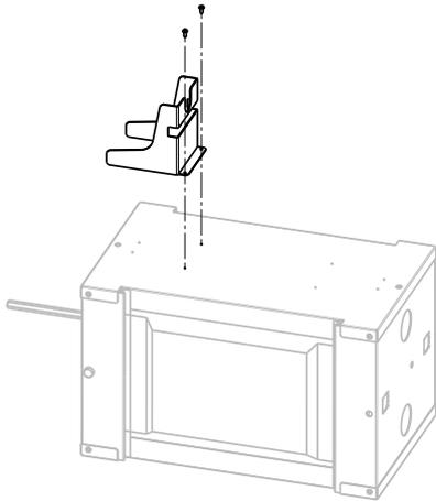
Abstützung (Pos. 7.5) für das Ausdehnungsgefäß (Pos. 9) mit den Schrauben (Pos. 7.7) montieren
