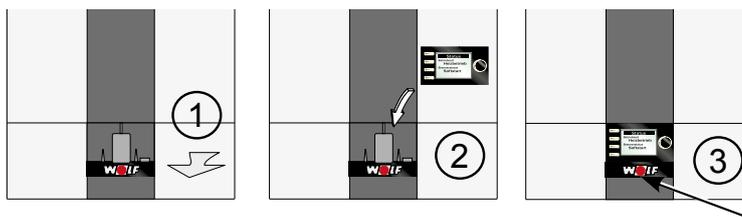
Stromversorgung / Sicherung einschalten und Betriebsschalter einschalten.
