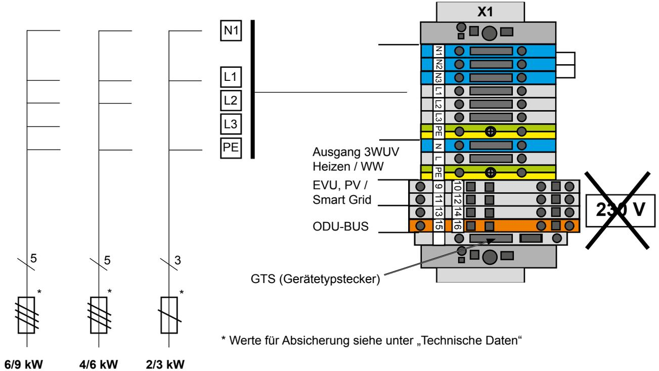
Bei BWL-1S mit eingebauter 3-phasiger Elektro-Heizung kann diese wahlweise 1-phasig, 2-phasig oder auch 3-phasig angeschlossen werden. Je nach Anforderung schaltet die Regelung die E-Heizung über ein Schütz zu.
