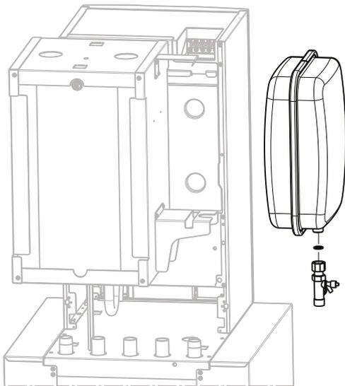
Ausdehnungsgefäß (Pos. 9) mit Flachdichtung (Pos.8.19) und Kappenventil (Pos. 8.14) verschrauben
