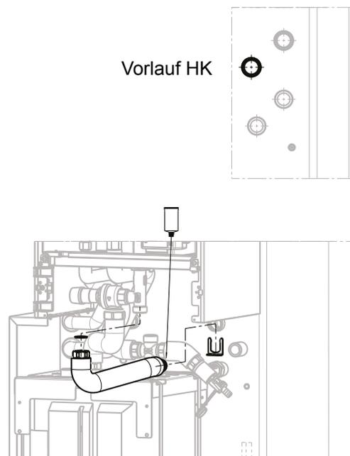
Wellrohr Vorlauf Heizung (Pos. 17.8) Art. Nr. 2072400 an O-Ring-Seite einfetten, in die Steckverbindung Vorlauf HK in den Speicher stecken und mit rechteckigen Clip (Pos. 17.14) sichern. Überwurfmutter-Seite mit Flachdichtung (Pos. 17.18) an die Abzweigung Überströmventil schrauben
