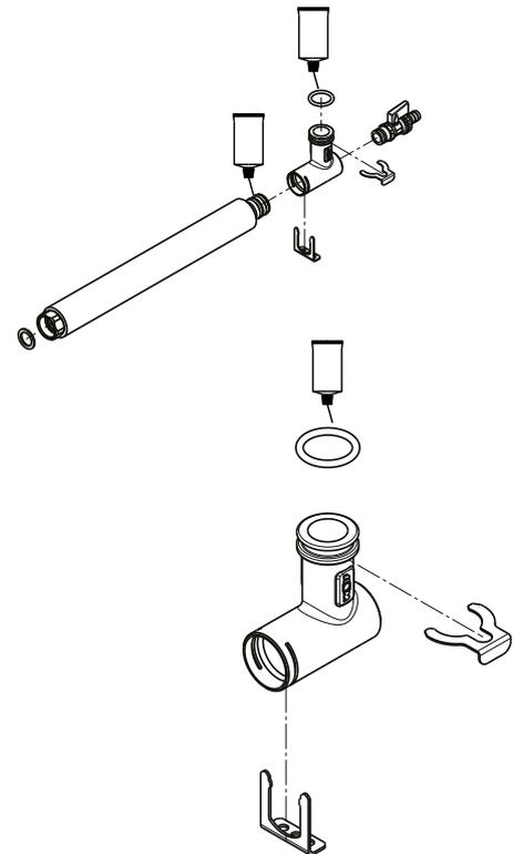
KFE-Kugelhahn (Pos. 8.2) in Anschlusswinkel (Pos. 8.1) einschrauben. Wellrohr Vorlauf Speicher (Pos. 8.9) Art. Nr. 2071921 an O-Ring-Seite einfetten, in Anschlusswinkel einstecken und mit rechteckigen Clip (Pos. 8.15) sichern. O-Ring (Pos. 8.17) in Nut am Anschlusswinkel einsetzen und einfetten. Flachdichtung (Pos. 8.20) für anschließende Montage vorbereiten
