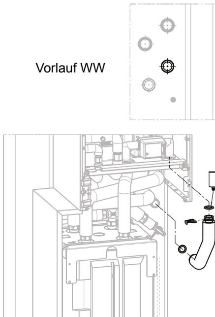
Wellrohr Vorlauf Speicher (Pos. 20.3) Art. Nr. 2072397 mit O-Ring (Pos. 20.14) versehen, einfetten und in die Inneneinheit einstecken und mit dem Verrohrungsclip DN 28 (Pos. 20.13) sichern. Überwurfmutter-Seite mit Flachdichtung (Pos. 20.16) am Vorlauf WW des Speichers festschrauben
