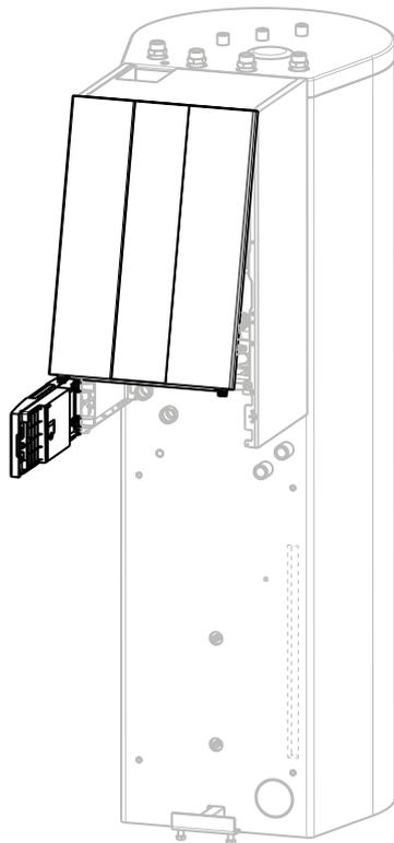
Aufklappen der Regelungsblende und entfernen der Frontverkleidung
