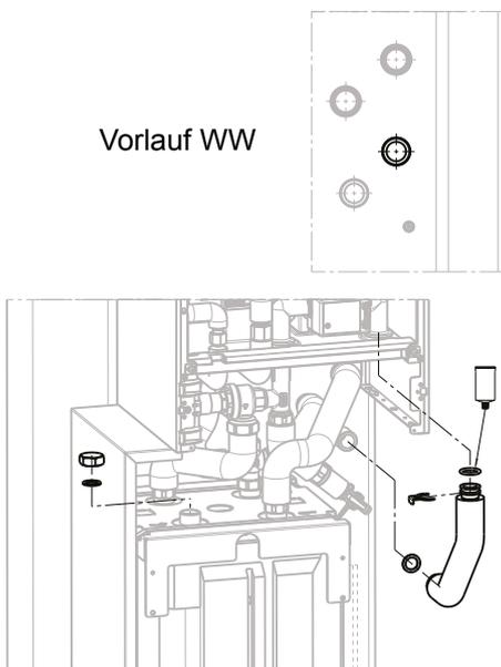
Wellrohr Vorlauf Speicher (Pos. 17.5) Art. Nr. 2072397 mit O-Ring (Pos. 17.16) versehen, einfetten und in die Inneneinheit einstecken und mit dem Verrohrungsclip DN 28 (Pos. 17.15) sichern. Überwurfmutter-Seite mit Flachdichtung (Pos. 17.18) am Vorlauf WW des Speichers festschrauben. Pufferspeicher „Anschluss 4“ mit Flachdichtung (Pos. 17.18) und Verschlusskappe (Pos. 17.13) verschließen
