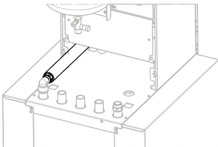
Vormontiertes Wellrohr (siehe Schritt 10.11) inkl. Flachdichtung mit Anschlussbogen VL Speicher verschrauben, den Anschlusswinkel am Wellrohr mit der Inneneinheit verbinden und mit Verrohrungsclip DN 28 (Pos. 2.3) sichern
