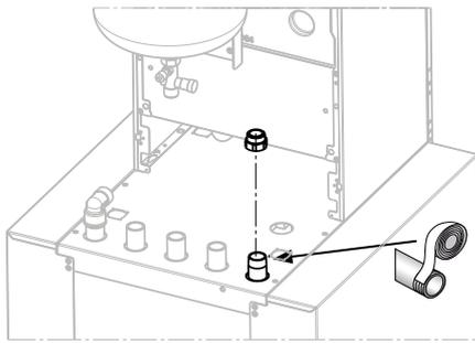
Anschlussübergang (Pos. 2.12) an RL Speicher (Symbol) mit geeignetem Dichtmaterial aufdichten
