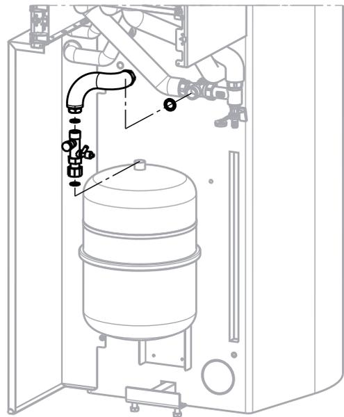
Kappenventil (Pos. 12.8) mit Flachdichtung (Pos. 12.12) am Ausdehnungsgefäß anschrauben. Wellrohr DN 15 (Pos. 12.7) gemäß Bild vorbiegen und unter Verwendung der Flachdichtungen (Pos. 12.12 und 12.13) mit Kappenventil und Kreuzstück verbinden
