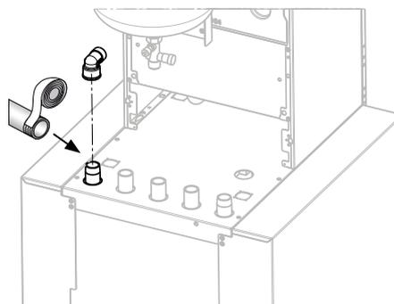
Anschlussbogen 90° (Pos. 2.13) an VL Speicher (Symbol) mit geeignetem Dichtmaterial aufdichten. Anschluss muss in Richtung der Inneneinheit zeigen
