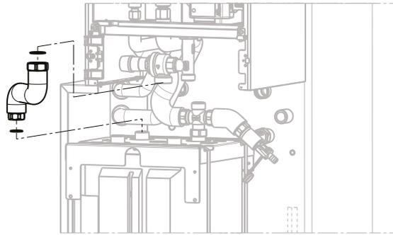
Wellrohr Überströmleitung (Pos. 17.10) Art. Nr. 2072402 mit Flachdichtungen (Pos. 17.18 und 17.19) mit Überströmventil und Pufferspeicher „Anschluss 3“ verbinden
