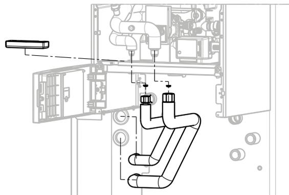
Rohrfixierung entfernen und Kältemittelleitungen (Pos. 13.1 und Pos. 13.2) unter Verwendung der Kupfer-Dichtungen (Pos. 13.3 und Pos. 13.4) an Inneneinheit anbringen und mit dem entsprechenden Drehmoment anziehen
