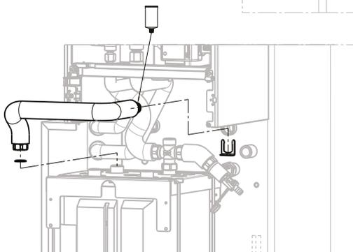
Wellrohr Vorlauf Heizung (Pos. 20.7) Art. Nr. 2072406 an O-Ring-Seite einfetten, in die Steckverbindung Vorlauf HK in den Speicher stecken und mit rechteckigen Clip (Pos. 20.12) sichern.
