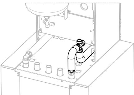
Vormontierte Wellrohre (siehe Schritt 10.12) inkl. Flachdichtung mit Anschlussübergang RL Speicher verschrauben, den Anschlusswinkel am Wellrohr mit der Inneneinheit verbinden und mit Verrohrungsclip DN 28 (Pos. 2.3) sichern
