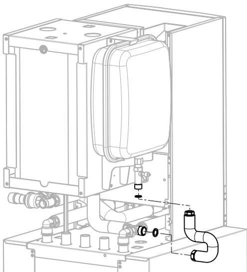
Wellrohr DN15 (Pos. 8.13) gemäß Bild vorbeugen und dann unter Verwendung der Flachdichtungen (Pos. 8.19 und Pos. 8.20) mit Kreuzstück und Ausdehnungsgefäß verbinden
