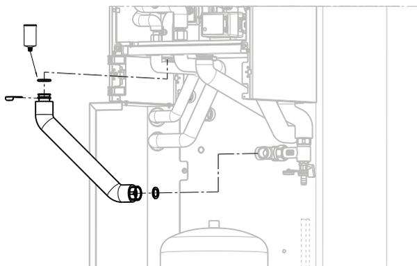
Wellrohr Rücklauf Gerät (Pos. 12.4) Art. Nr. 2072547 mit O-Ring (Pos. 12.11) versehen, einfetten und in die Inneneinheit einstecken und mit dem Verrohrungsclip DN 28 (Pos. 12.10) sichern. Überwurfmutter-Seite mit Flachdichtung (Pos. 12.13) am Kreuzstück festschrauben
