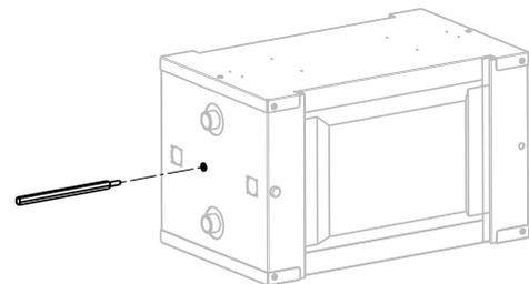
Distanzhülse (Pos. 8.8) bis zum Anschlag in Speicher einschrauben
