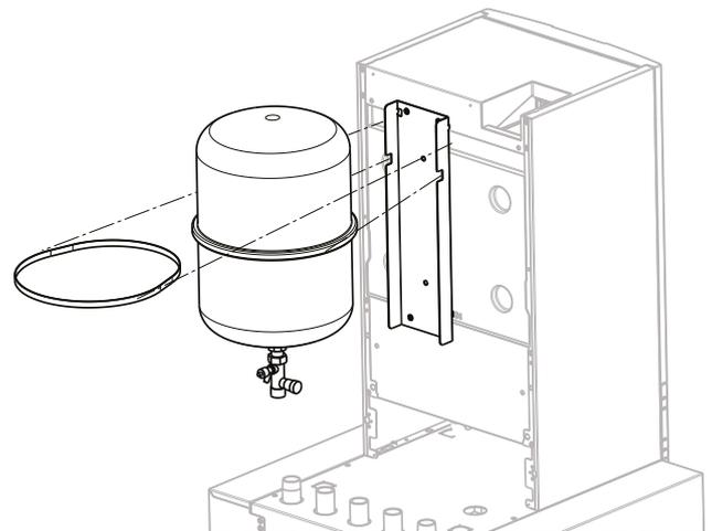
Halteband (In Verpackungseinheit MAG enthalten) hinter den Halter einfädeln
