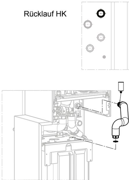
Wellrohr Rücklauf Heizung (Pos. 17.9) Art. Nr. 2072401 an O-Ring-Seite einfetten, in die Steckverbindung Rücklauf HK in den Speicher stecken und mit rechteckigen Clip (Pos. 17.14) sichern. Überwurfmutter-Seite mit Flachdichtung (Pos. 17.18) am Pufferspeicher „Anschluss 1“ festschrauben
