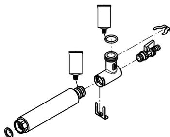
KFE-Kugelhahn (Pos. 8.2) in Anschlusswinkel (Pos. 8.1) einschrauben. Wellrohr Rücklauf Gerät (Pos. 8.12) Art. Nr. 2072395 an O-Ring-Seite einfetten, in Anschlusswinkel einstecken und mit rechteckigen Clip (Pos. 8.15) sichern. O-Ring (Pos. 8.17) in Nut am Anschlusswinkel einsetzen und einfetten. Flachdichtung (Pos. 8.20) für anschließende Montage vorbereiten
