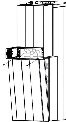
Frontblech mit Schrauben (Pos 10.5) montieren
