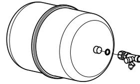
Kappenventil (Pos. 5.3) mit Dichtung (Pos 5.4) an Membranausdehnungsgefäß (Pos. 4) aufschrauben.
