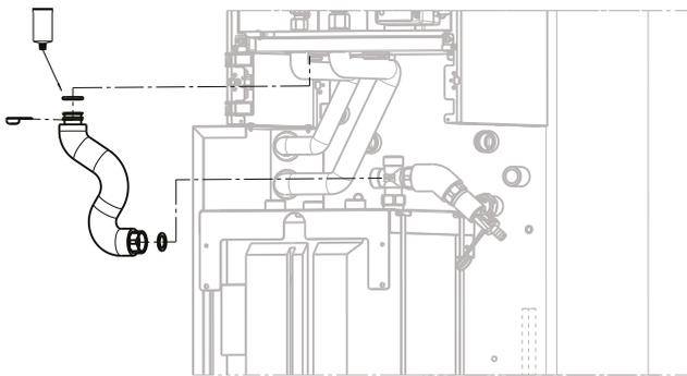
Wellrohr Rücklauf Gerät (Pos. 17.7) Art. Nr. 2072399 mit O-Ring (Pos. 17.16) versehen, einfetten und in die Inneneinheit einstecken und mit dem Verrohrungsclip DN 28 (Pos. 17.15) sichern. Überwurfmutter-Seite mit Flachdichtung (Pos. 17.18) am Kreuzstück festschrauben
