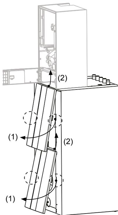
Frontverkleidung Speicher durch zusammendrücken der zentralen Einrastpunkte (1) aufhebeln und nach oben herausschwenken (2)
