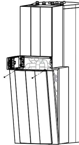
Frontblech mit Schrauben (Pos 10.5) montieren
