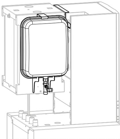
Das Ausdehnungsgefäß in die dafür vorgesehene Aussparung der Abstützung einsetzen und mit der oberen Lasche sichern
