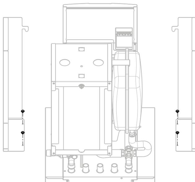
je 2 x Klammern (Pos. 7.6) in Seitenverkleidung links (Pos. 7.2) und Seitenverkleidung rechts (Pos. 7.1) einclipen
