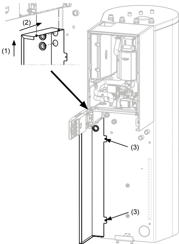
Einhängen der Seitenverkleidung links (Pos. 10.2) und einsetzen der Dichtmanschetten (Pos 10.3). Seitenverkleidung mit zwei Schrauben (Pos. 10.4) am Speicher festschrauben
