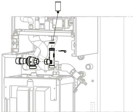
Abzweigung Überströmventil (Pos. 17.1) in Überströmventil (Pos. 17.2) mit geeignetem Dichtmaterial einschrauben. Mit O-Ring (Pos. 17.16) versehen, einfetten und in die Inneneinheit stecken und mit Verrohrungsclip DN 28 (Pos. 17.15) sichern
