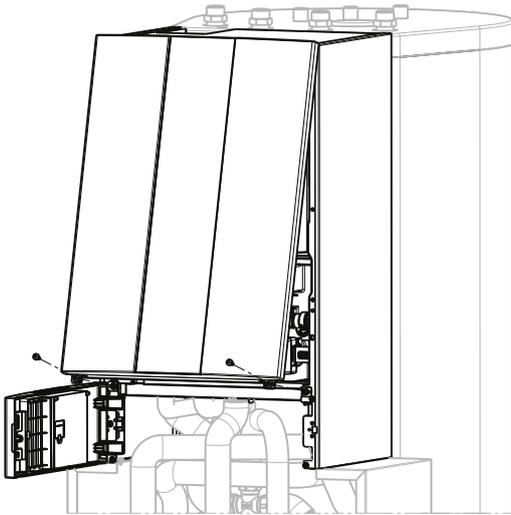
Frontverkleidung der Inneneinheit montieren
