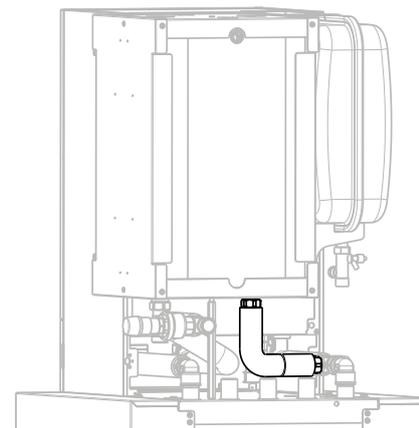
Wellrohr Anbindung Puffer (Pos. 8.11) mit 2x Flachdichtungen (Pos. 8.20) seitlich am Kreuzstück und am Pufferspeicher verschrauben
