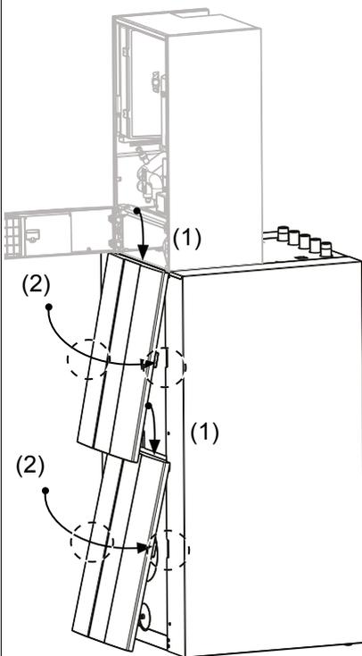
Frontverkleidung in umgekehrter Reihenfolge wieder montieren.
