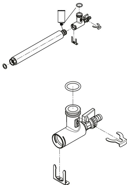
KFE-Kugelhahn (Pos. 2.15) in Anschlusswinkel (Pos. 2.1) einschrauben. Wellrohr Vorlauf Speicher (Pos. 2.7) Art. Nr. 2071921 an O-Ring-Seite einfetten, in Anschlusswinkel einstecken und mit rechteckigen Clip (Pos. 2.2) sichern. O-Ring (Pos. 2.4) in Nut am Anschlusswinkel einsetzen und einfetten. Flachdichtung (Pos. 2.9) für anschließende Montage vorbereiten
