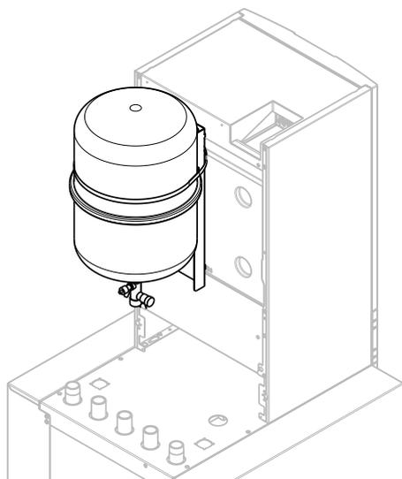
MAG mittels Halteband befestigen
