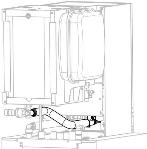
Vormontiertes Wellrohr (siehe Schritt 11.19) mit dem Anschlusswinkel in die Inneneinheit stecken und mit Verrohrungsclip DN 28 (Pos. 8.16) sichern. Überwurfmutter des Wellrohres mit Flachdichtung (Pos. 8.20) und T-Stück am Überströmventil verschrauben
