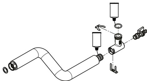
KFE-Kugelhahn (Pos. 8.2) in Anschlusswinkel (Pos. 8.1) einschrauben. Wellrohr Vorlauf Heizung (Pos. 8.10) Art. Nr. 2072393 an O-Ring-Seite einfetten, in Anschlusswinkel einstecken und mit rechteckigen Clip (Pos. 8.15) sichern. O-Ring (Pos. 8.17) in Nut am Anschlusswinkel einsetzen und einfetten. Flachdichtung (Pos. 8.20) für anschließende Montage vorbereiten
