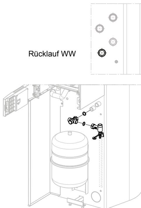
Kreuzstück (Pos. 12.1) mit der Überwurfmutter-Seite und Flachdichtung (Pos. 12.13) an den Rücklauf WW des Speichers schrauben. Anschlusswinkel inkl. Entleerungshahn (Pos. 12.2) mit Flachdichtung (Pos. 12.13) seitlich an das Kreuzstück schrauben. Die Ausrichtung der Bauteile gemäß Bild beachten
