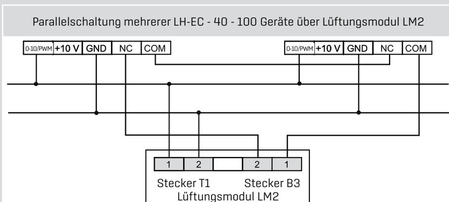
Mit einem Lüftungsmodul LM2 können bis zu 5 LH-EC - 40 - 100 Geräte stufenlos betrieben werden.
