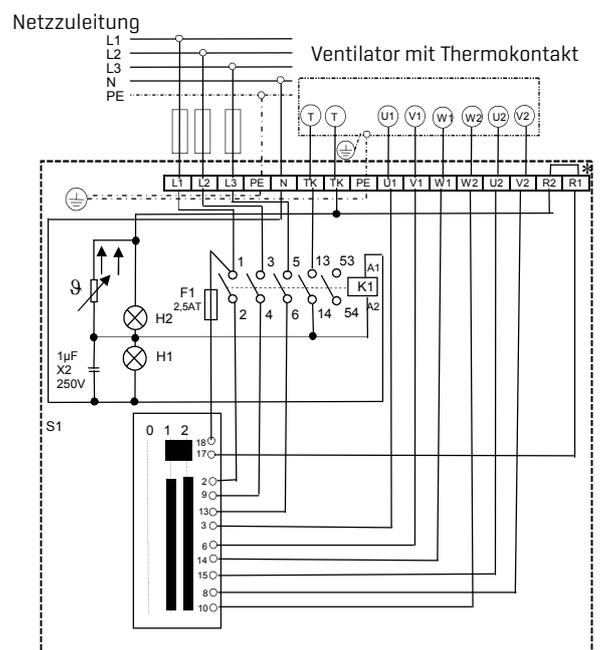
\* Bei Anschluß eines Raumthermostats Brücke entfernen
