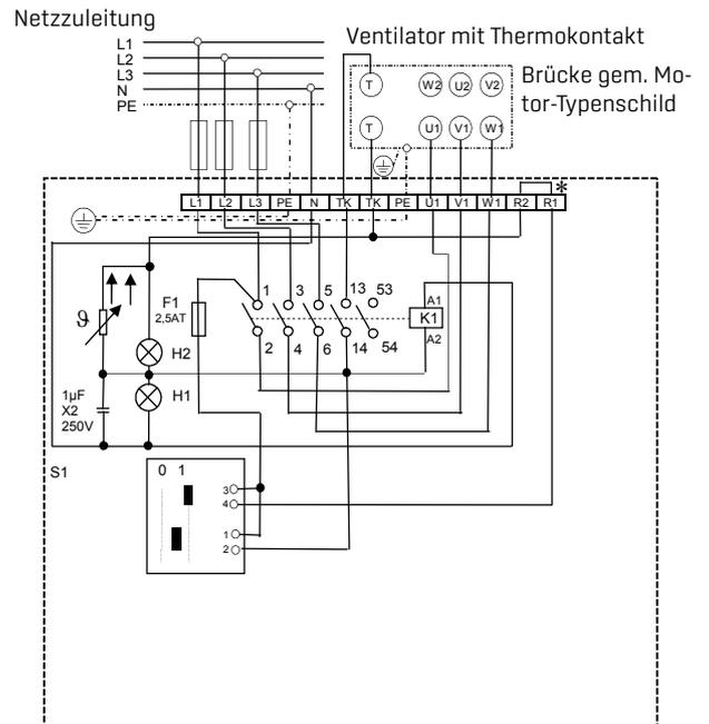
\* Bei Anschluß eines Raumthermostats Brücke entfernen
