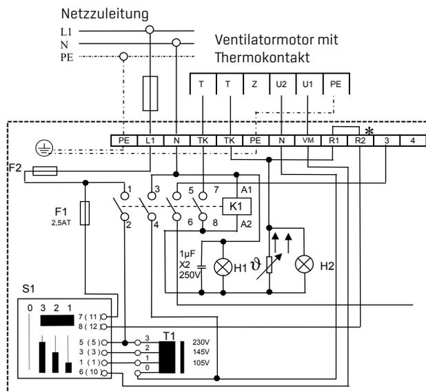
\* Bei Anschluß eines Raumthermostats Brücke entfernen
