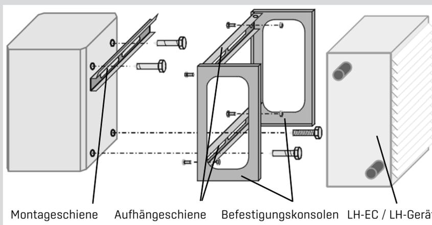
Montagewise    Aufhängewise    Befestigungskonsolen    LH-EC / LH-Gerät
