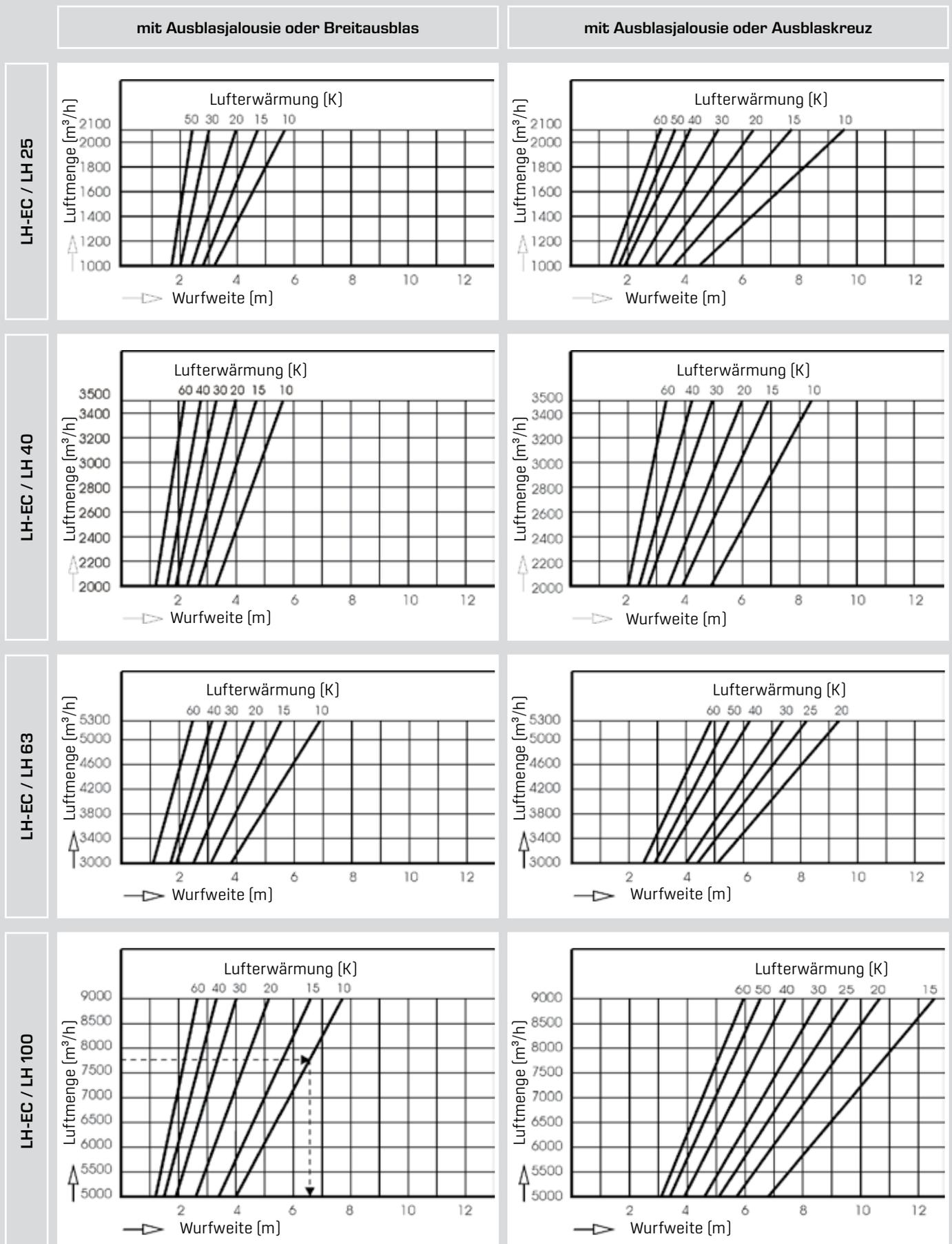
Beispiel: LH 100 mit Ausblasjalousie;  $\Delta t_L = t_{LAeff} - t_{Raum} = 10 \text{ K}$ ; Luftmenge =  $7\,750 \text{ m}^3/\text{h}$
