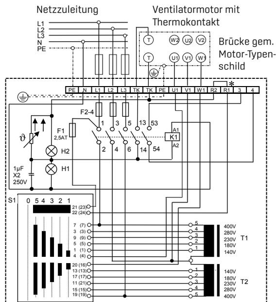
\* Bei Anschluß eines Raumthermostats Brücke entfernen
