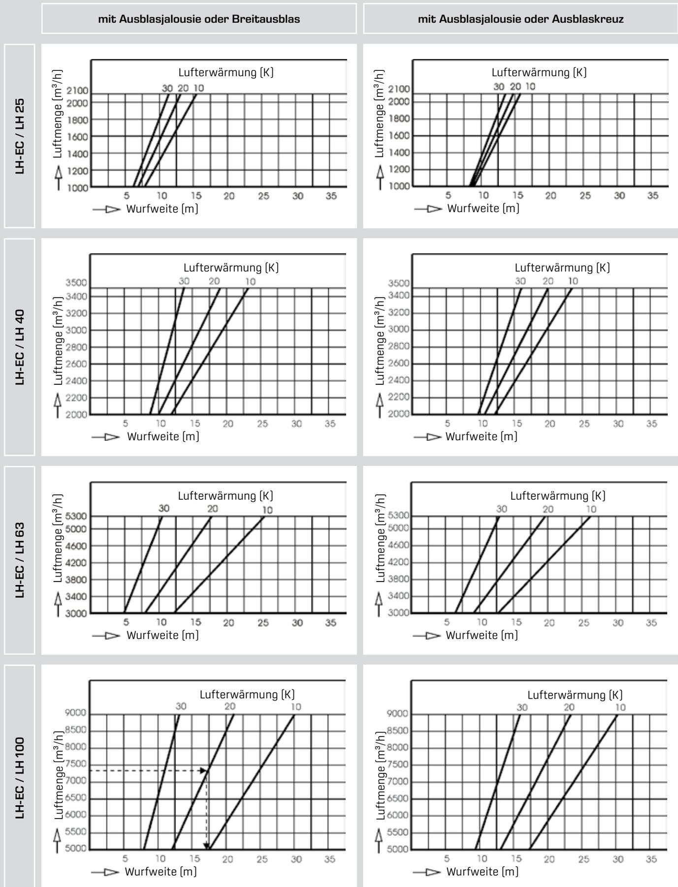
Beispiel: LH 100 mit Ausblasjalousie;  $\Delta t_L = t_{L\text{eff}} - t_{\text{Raum}} = 20 \text{ K}$ ; Luftmenge =  $7\,300 \text{ m}^3/\text{h}$
