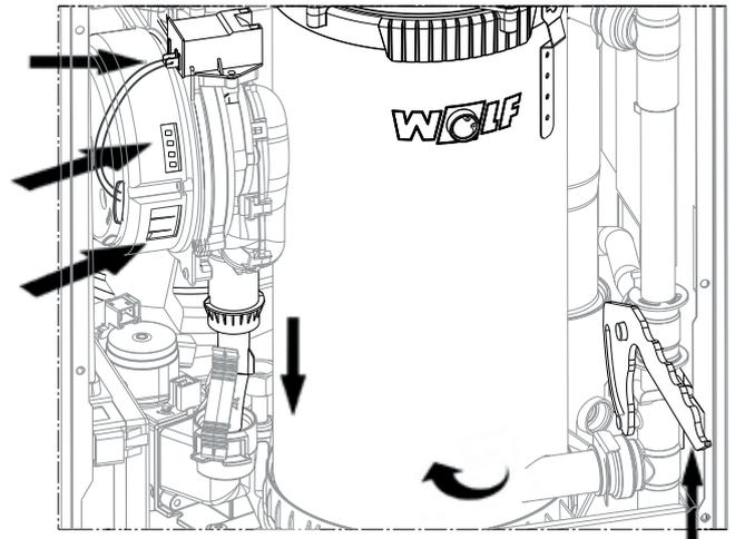
Sicherungsklammer an der Drehdurchführung einrasten.
