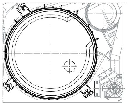
Bei Wasserverlust Vordruck am Ausdehnungsgefäß prüfen.
