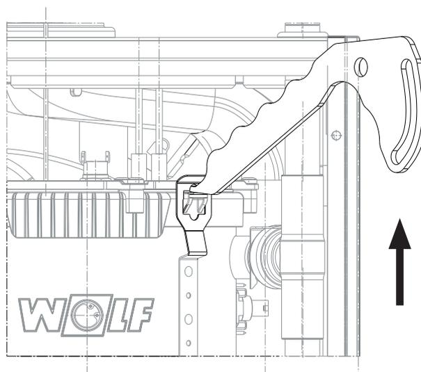
Stecker Zündelektrode, Ionisationselektrode, Zündtrafo und STB zusammenstecken.
