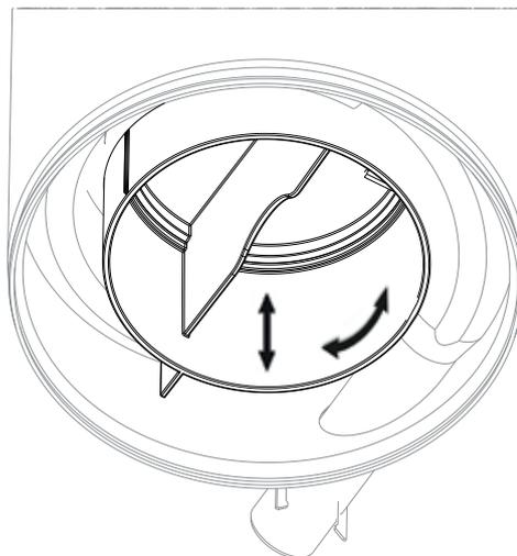
Brennkammerdeckel auf die Brennkammer setzen und gleichmäßig nach unten drücken.
