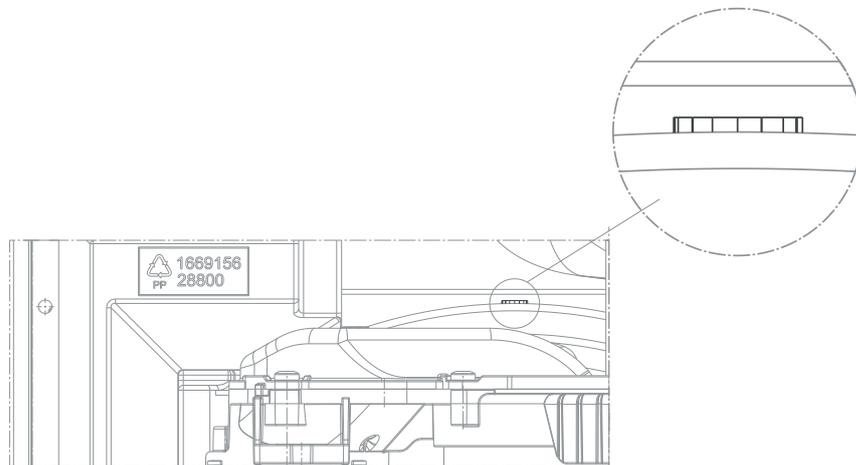
Brennkammerdichtung oben und unten ersetzen.
