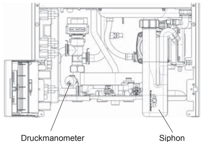
Kaltwasser absperrn und Anlage hydraulisch drucklos machen.
